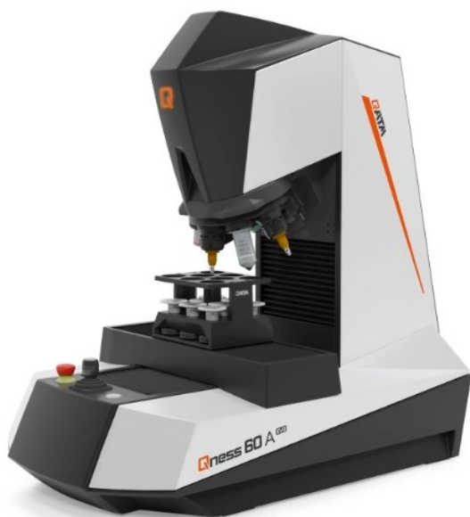
Fig. 26 Microdurometro Qness60 A Evo con le rispettive ottiche e l'indentatore
