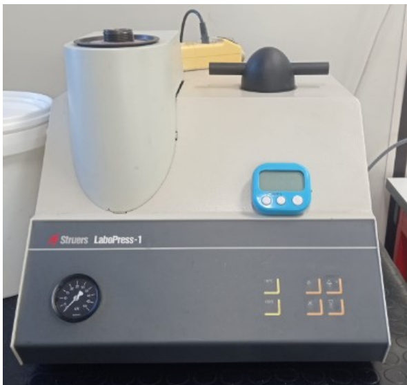
Fig. 23 Inglobatrice Struers LaboPress-1
