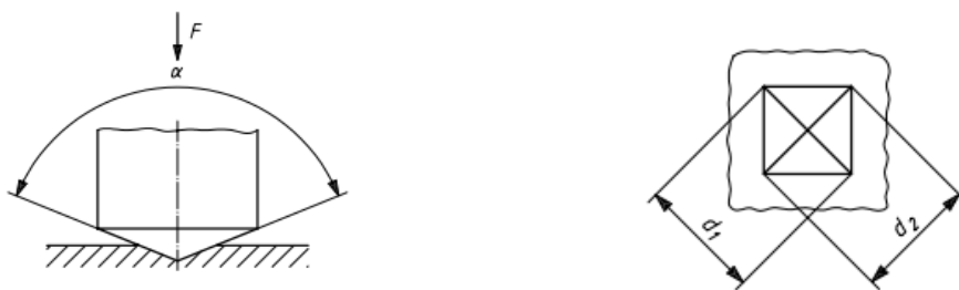
Fig. 17 Rappresentazione della prova Vickers
