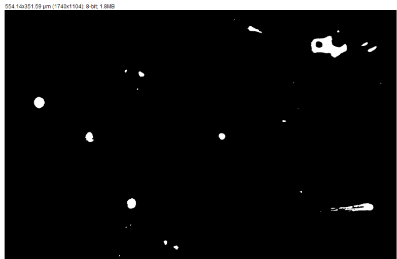
Fig. 31 Superficie campione As-Built lucidato dopo l'applicazione del comando Make binary del software ImageJ
