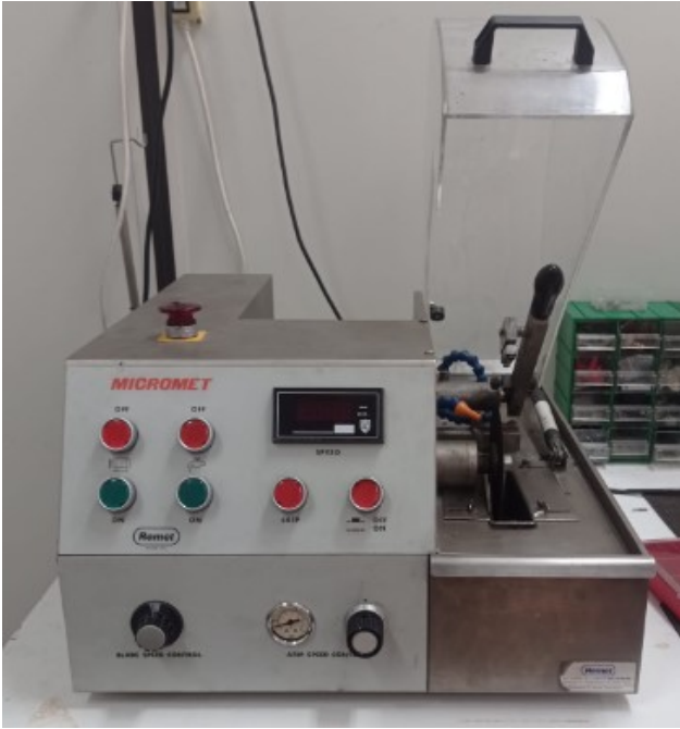
Fig. 21 Troncatrice metallografica automatica Remet modello micromet
