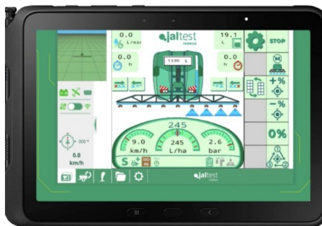
Figura 5 gestione isobus dell'irroratrice
