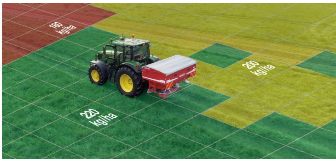
Figura 3 spandiconcime rateo variabile che effettua una distribuzione diversa in base alla zona
