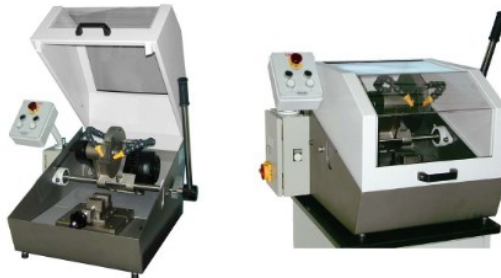
Figura 4.2 Troncatrici TR60 e TR60-70 utilizzate per il taglio di precisione dei campioni metallografici.
