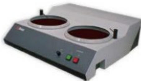
Figura 4.5 Smerigliatrice a dischi orizzontali con flusso continuo di acqua, modello Struers LaboPol-21.
