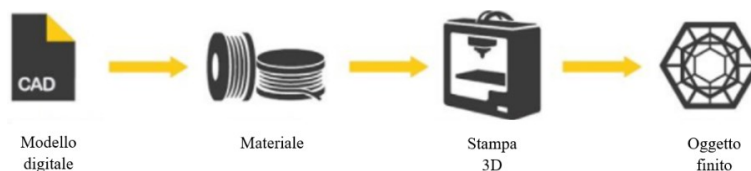
Figura 2.1 Passaggi per produrre un oggetto con un generico processo di Additive Manufacturing. [23]
