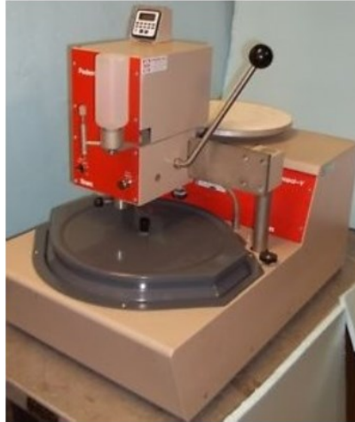
Figura 4.6 Lucidatrice Struers Planopol-V.
