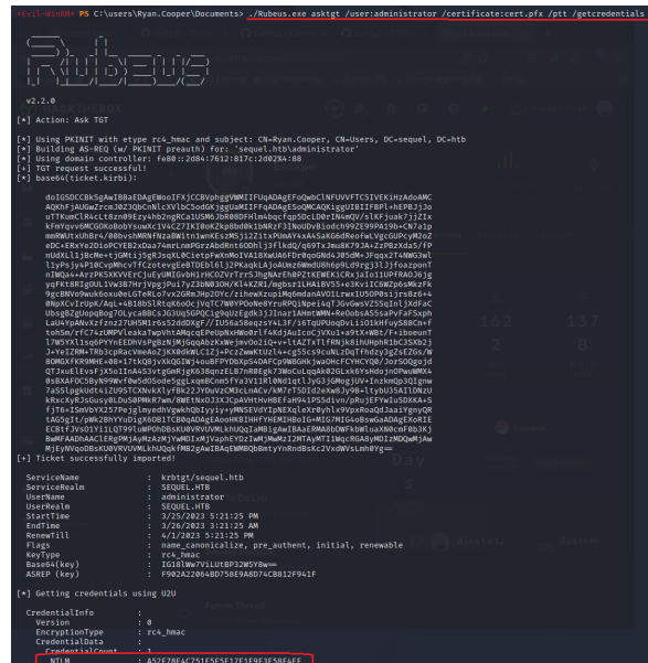
Figura 6.24: Generazione del TGT tramite Rubeus.exe
