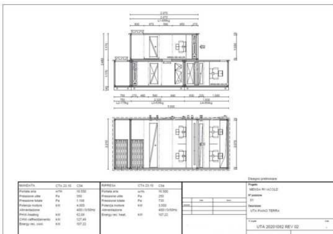
Figura : 5.26 Scheda tecnica UTA sala mensa
