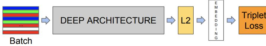
**Figura 6:** Struttura del modello FaceNet. Un batch di input viene inviato alla rete neurale adottata. All'output di quest'ultima viene applicata una normalizzazione L2, che determina l'ottenimento di un embedding. Questa sequenza è seguita dall'applicazione della funzione di triplet loss in fase di addestramento. (Fonte: [36])
