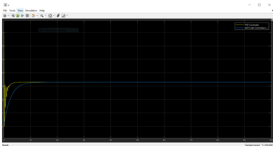
Figura n.19: Sforzo di controllo del pendolo con il PID (giallo) e sforzo di controllo del pendolo con PFDL (blu)
