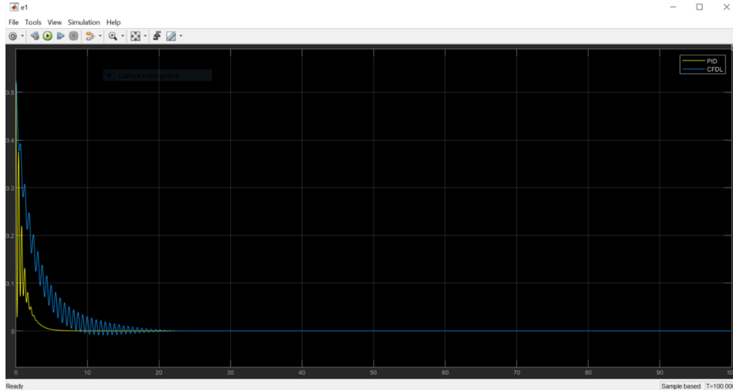
Figura n.11: Errore del pendolo con il PID (giallo) ed errore del pendolo con CFDL (blu)
