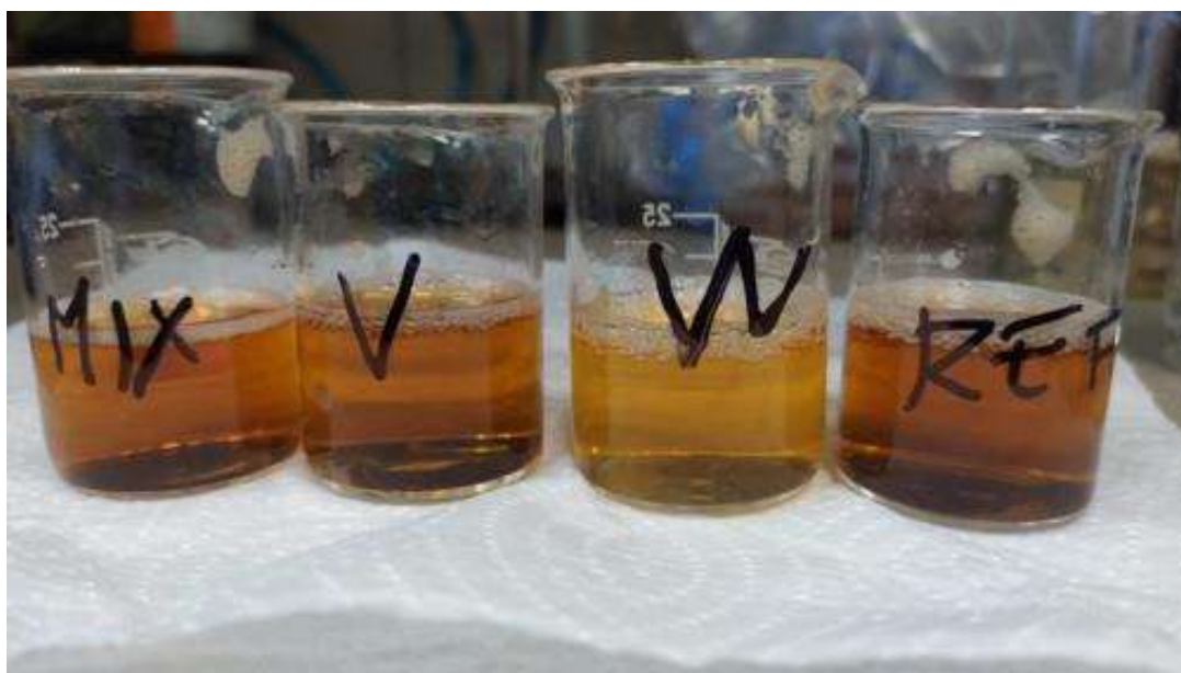
PFOS nel liciato dopo 4 ore con diversi elettrodi in immersione
