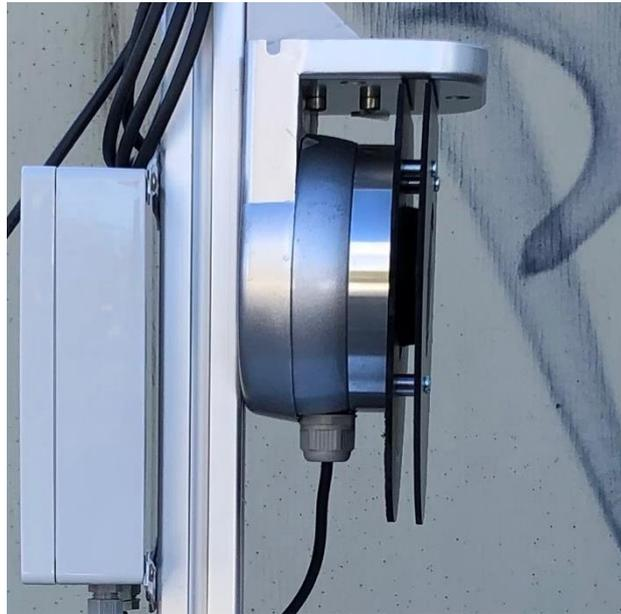
*Figura2: L'immagine rappresenta un sensore lidar.*
