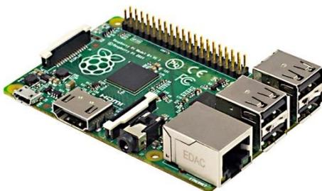
*Figura 8: L'immagine rappresenta un processore Raspberry Pi B+*
