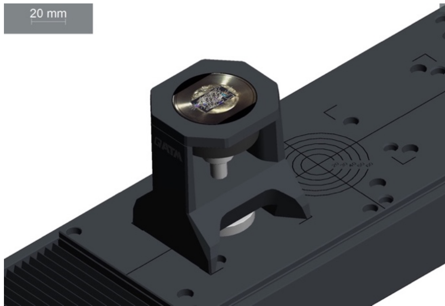
Figura 4. 15. Set-up prove di microdurezza su campione xy deformato dinamicamente.
