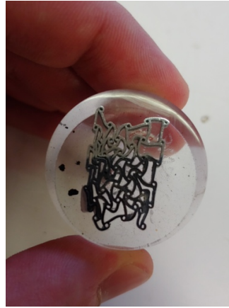
Figura 4. 3. Campione xy compresso dinamicamente e inglobato.
