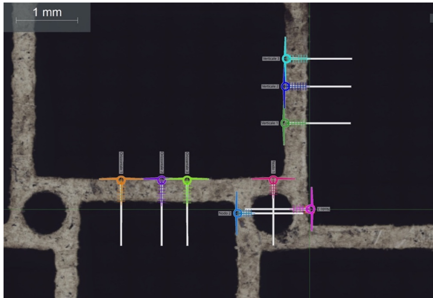
Figura 5. 16. Prove di microdurezza sul campione xy as-built.
