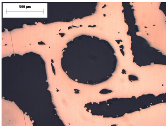
Figura 5. 1. Campione xy deformato dinamicamente osservato al MO con ingrandimento 2,5x1,88.
