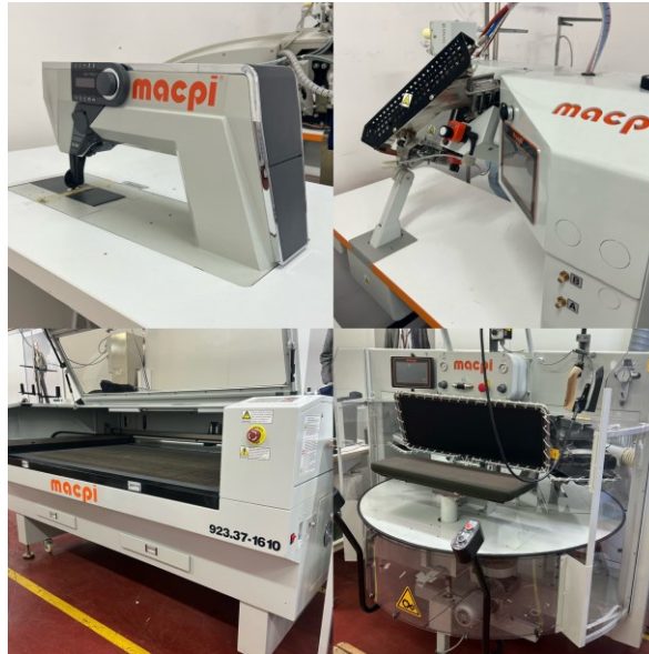
Fig. 55 Macchinari utilizzati per la termosaldatura
