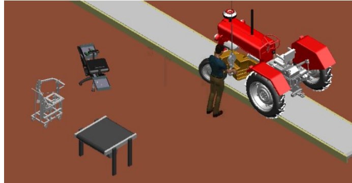
Figura 22. Sistemare serbatoio su staffe
