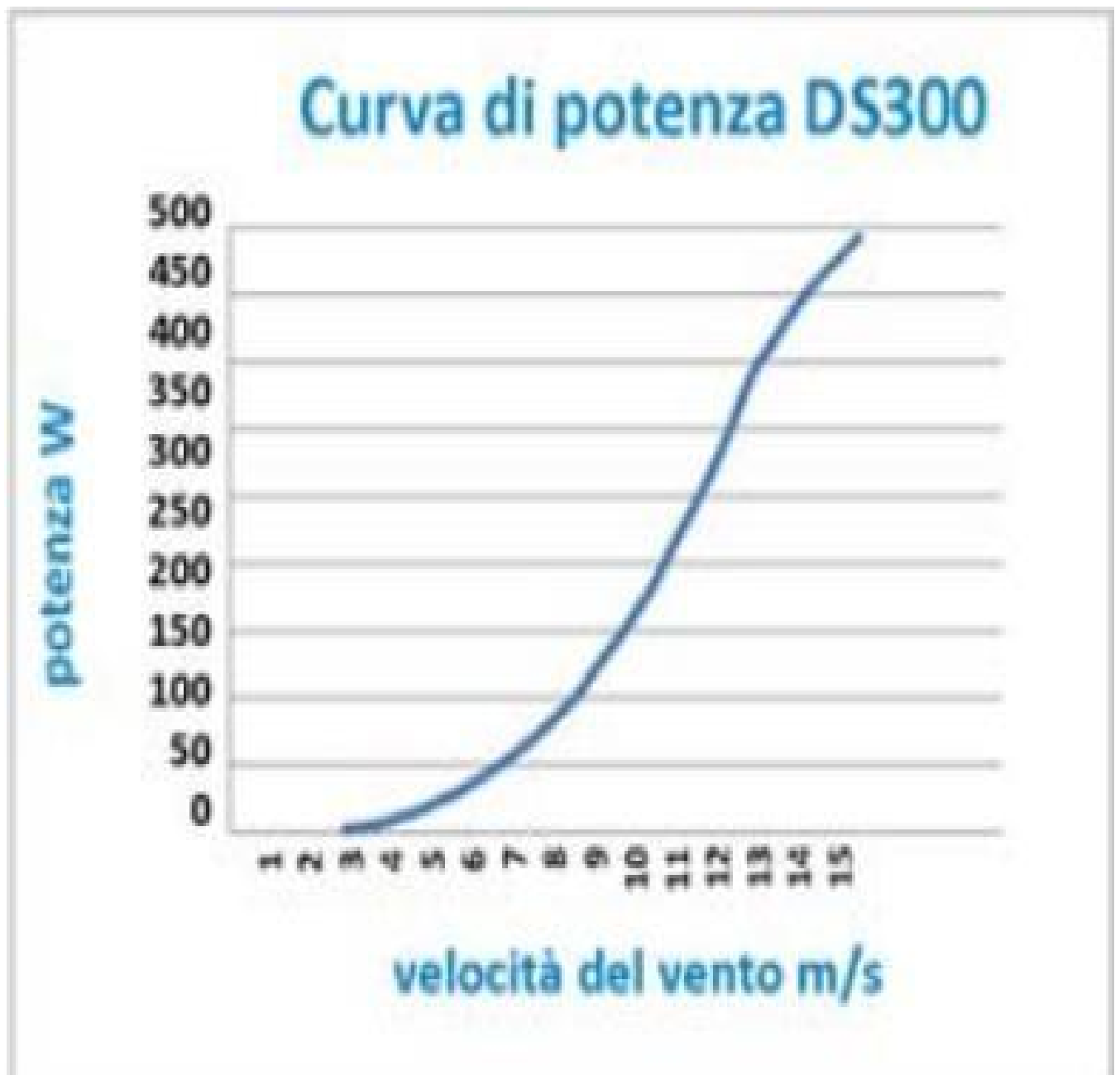
Figura 5 Grafico ingrandito della Curva di potenza della turbina analizzata
