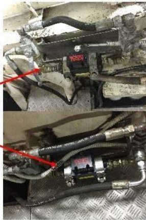
Figura 3. Sala macchine del peschereccio italiano Rapido "Midway" utilizzato come imbarcazione prototipo per il sistema di monitoraggio. A destra, i sensori del flusso di carburante (cerchiati in rosso), che misurano il consumo di carburante del motore principale.
