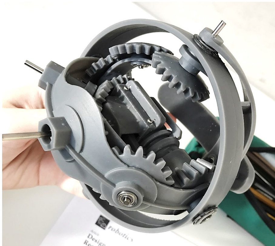
Figura 30. Il giunto sferico riconfigurabile completato
