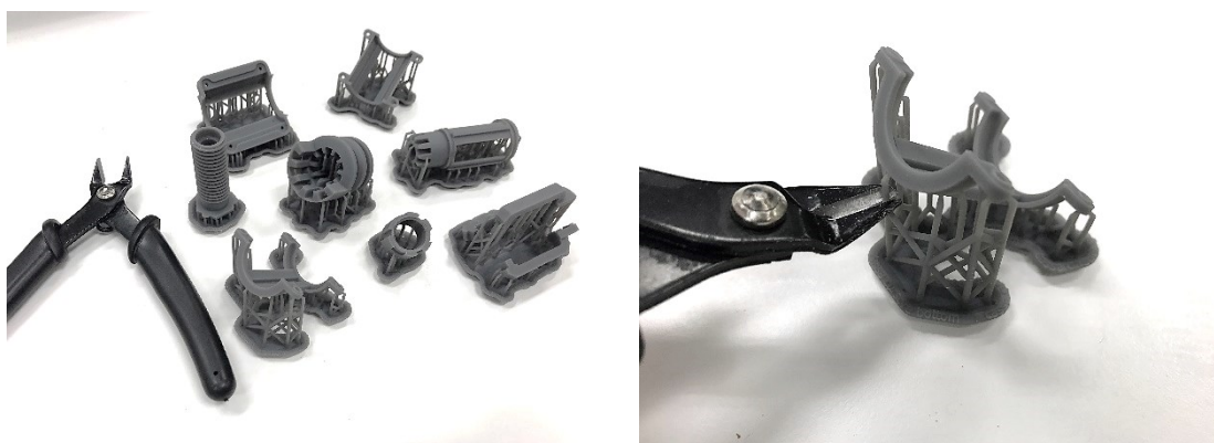
Figura 27. Rimozione dei supporti tramite le apposite tronchesi
