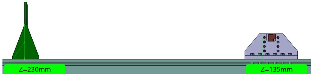
Figura 3.4: Comparazione dei punti di applicazione del precarico tra il prototipo e l'attuale sistema di pretensionamento.
