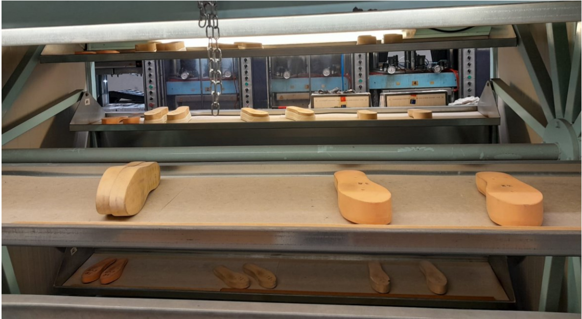
Figura 1.14 - "Girello" utilizzato per il raffreddamento delle soles
