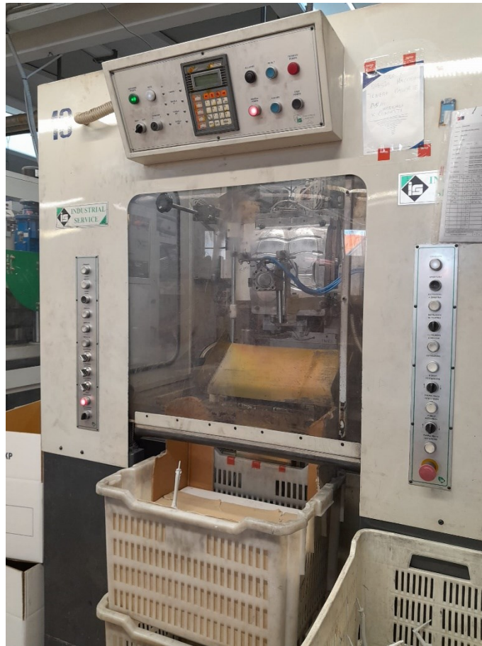
Figura 1.12 - Macchina 4.0 utilizzata per lo stampaggio
