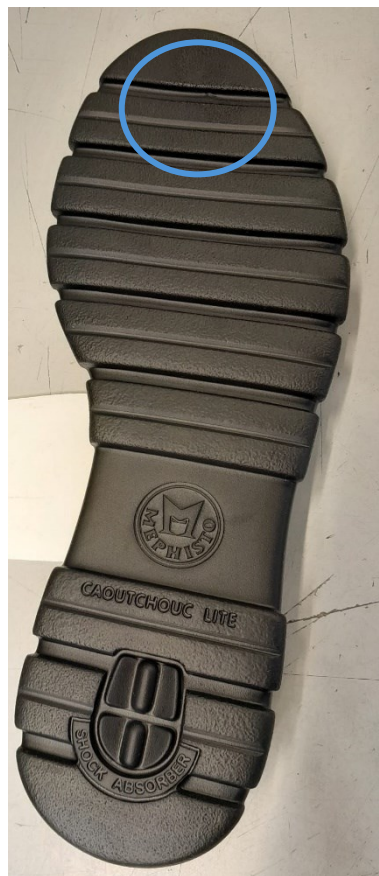
Figura 3.1 - Esempio di difetto rilevato sul retro della suola
