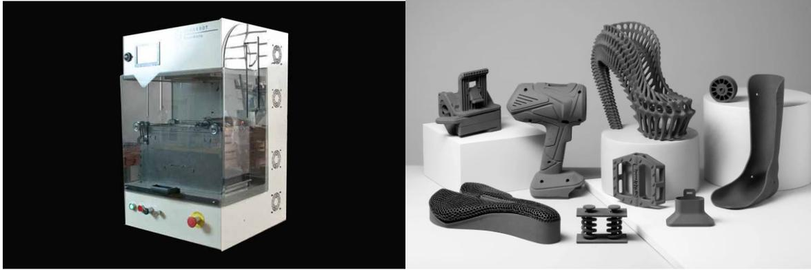
Figura 9- Materiali realizzati con stampa 3D SLS
