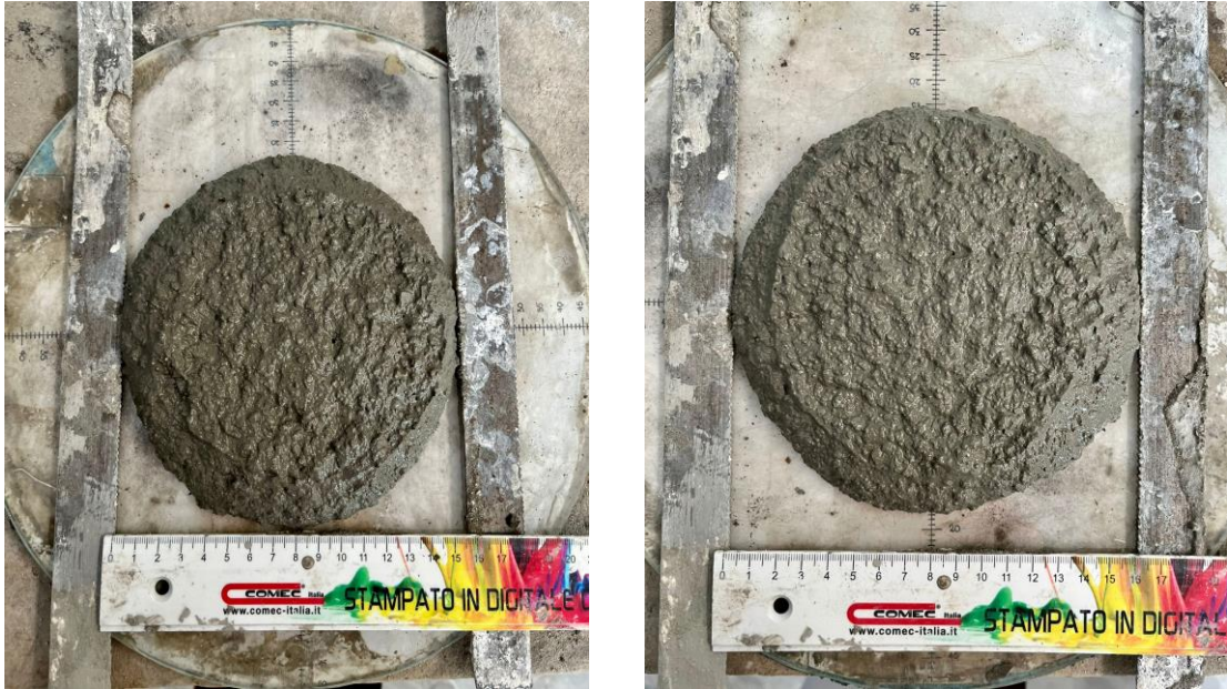
Figure 70 e 71: Prova lavorabilità per due provini di campione T1 40%.
