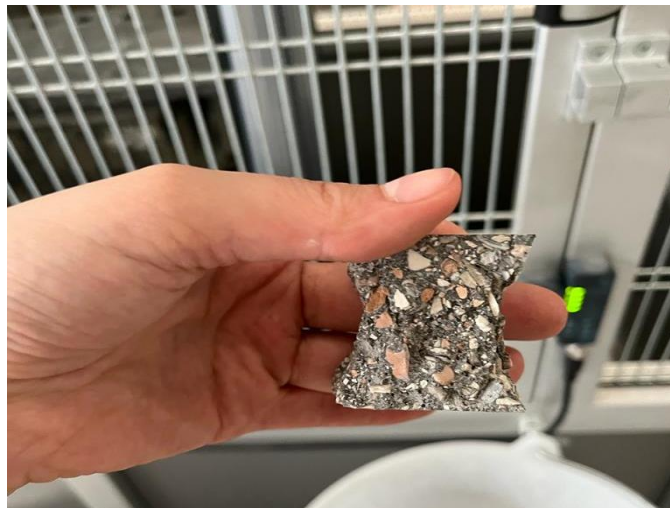
Figura 20: Foto provino dopo rottura per compressione.
