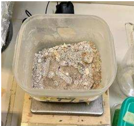
Figura 8: Preparazione provino con gusci.
