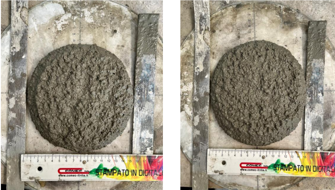
Figure 66 e 67: Prova lavorabilità per due provini di campione T1 10%.
