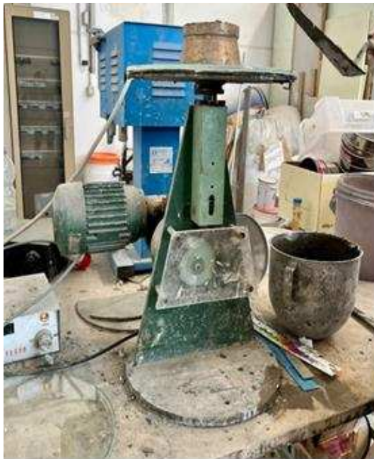
Figura 14: Prova di lavorabilità.
