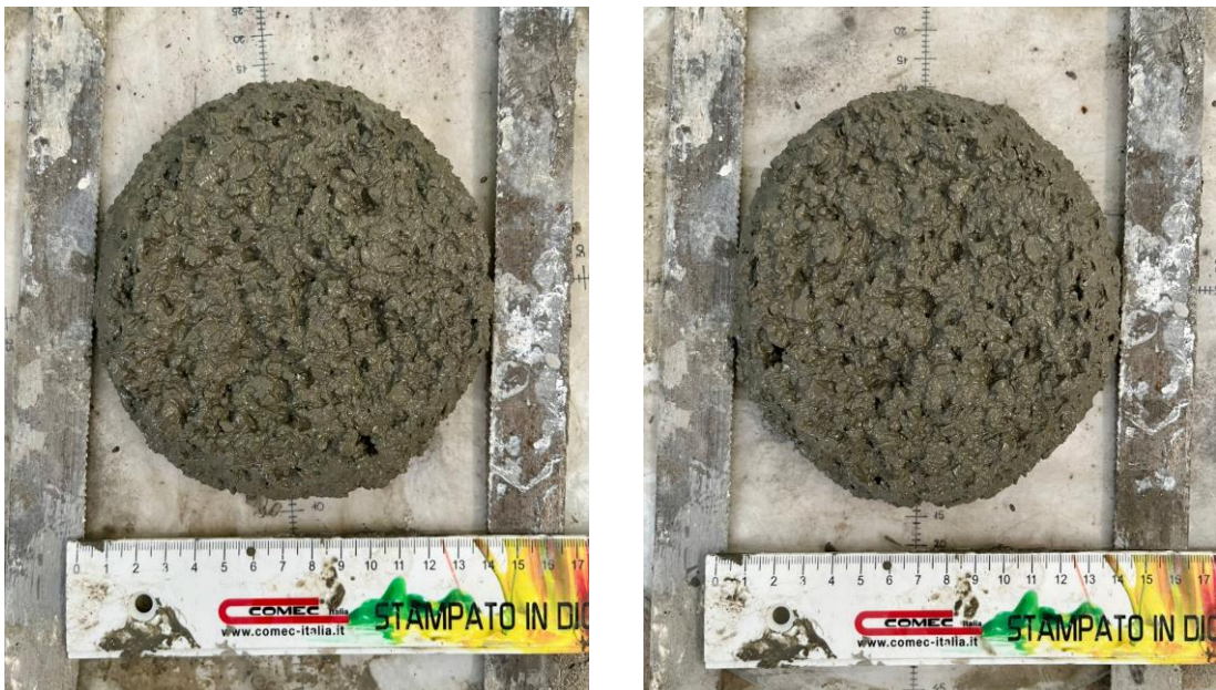
Figure 72 e 73: Prova lavorabilità per due provini di campione T2 10%.
