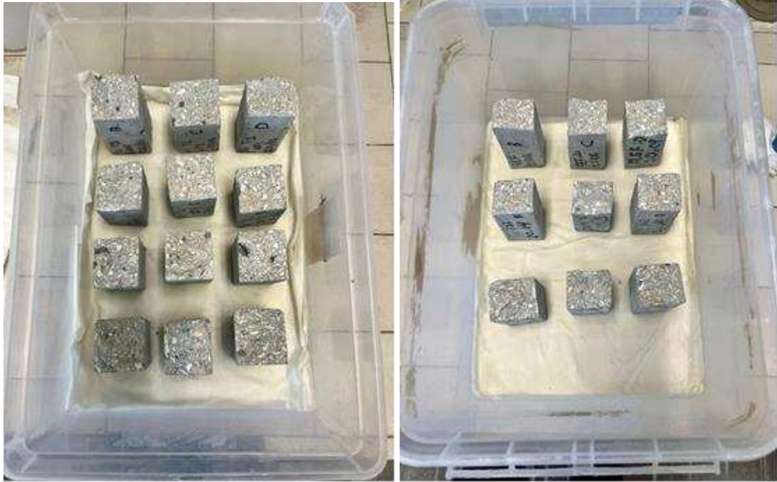
Figure 21 e 22: Foto provini posizionati sui fogli di carta filtro.
