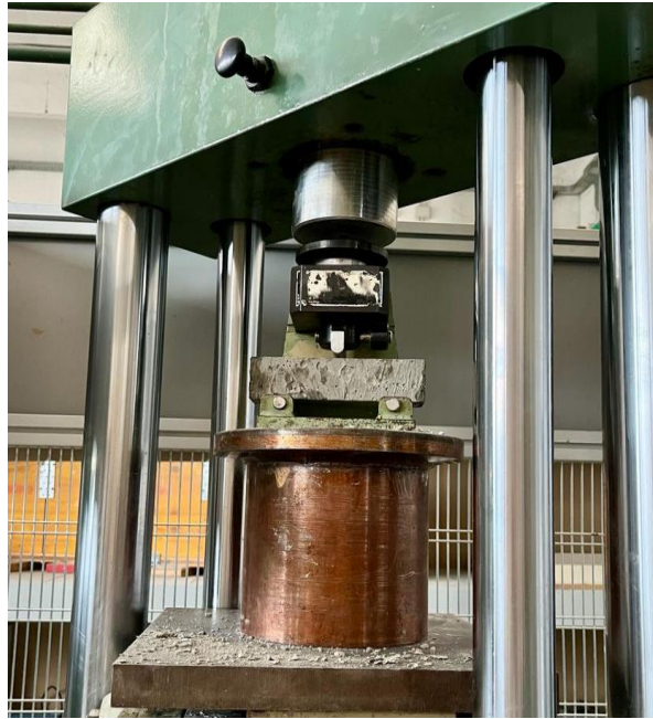
Figura 17: Foto portacampione per prova a flessione.
