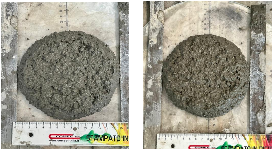
Figure 64 e 65: Prova lavorabilità per due provini di campione di riferimento.
