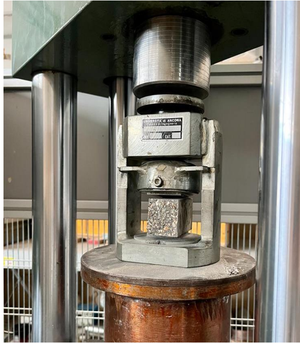
Figura 19: Foto portacampione per rottura a compressione.
