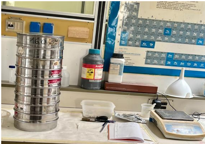
Figura 4: Foto piano di lavoro con selezione di setacci.
