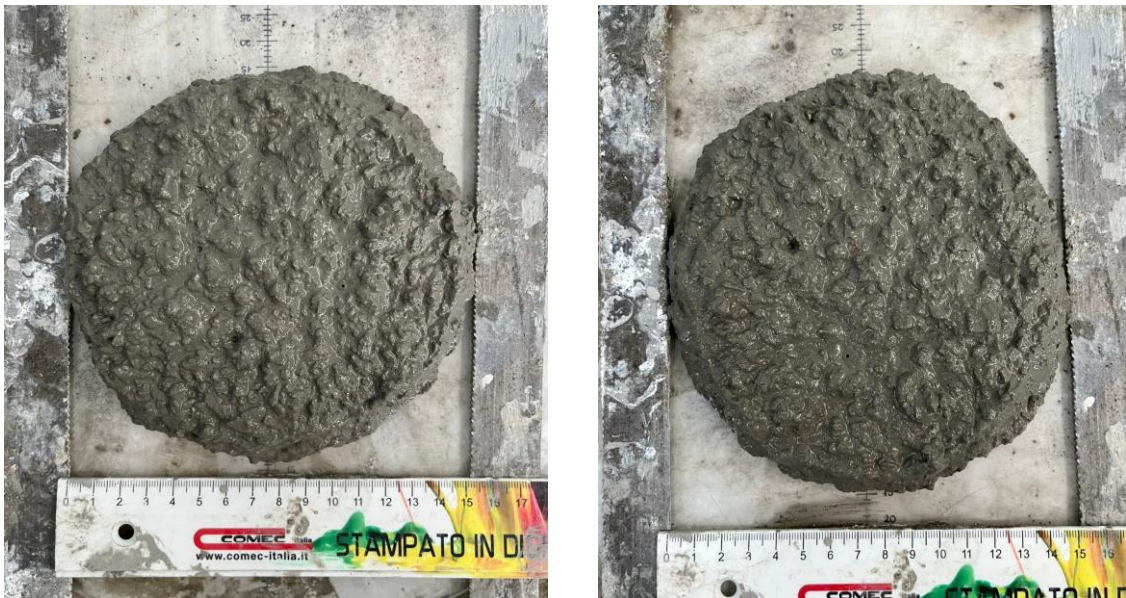
Figure 76 e 77: Prova lavorabilità per due provini di campione T2 40%.
