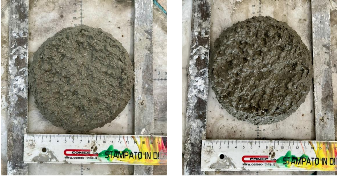
Figure 74 e 75: Prova lavorabilità per due provini di campione T2 20%.
