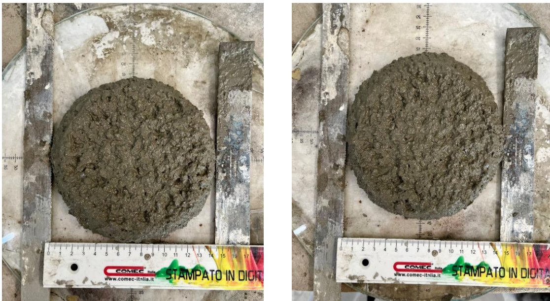
Figure 68 e 69: Prova lavorabilità per due provini di campione T1 20%.
