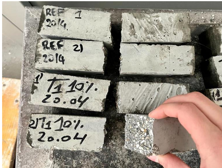
Foto 18: Foto campione dopo rottura a flessione.
