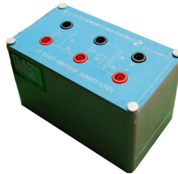
Figura 17: rete progettata secondo lo Standard IEC 60990 per la misura della corrente di tocco.
