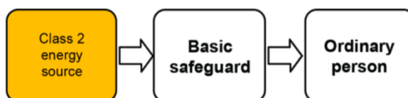
Figura 10: schema a blocchi delle salvaguardie per sorgenti energetiche classe II e la persona ordinaria.
