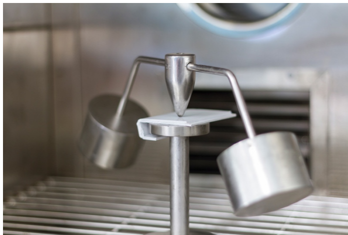
Figura 18: strumentazione per la prova di pressione della biglia conforme alla IEC 60695-10-2.
