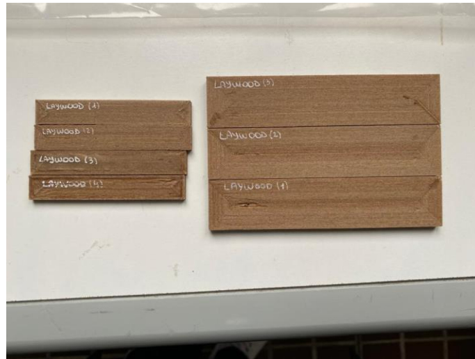
Figura15. Immagine di alcuni provini Laywood realizzati mediante stampa 3D
