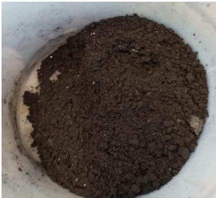
Campione di 'Polvere di carbonio' utilizzato per l'analisi granulometrica
