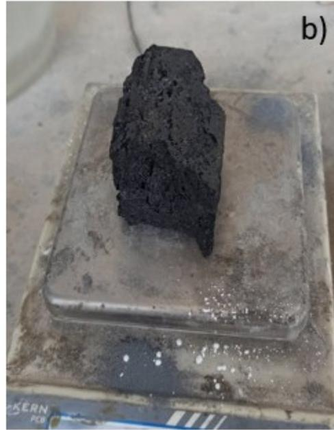
*Fig. 5.4 - Setup di prova per la determinazione della massa volumica. Immersione del campione nel contenitore per misurare l'innalzamento dell'acqua (a) e successivamente valutazione della variazione di massa del provino (b).*
