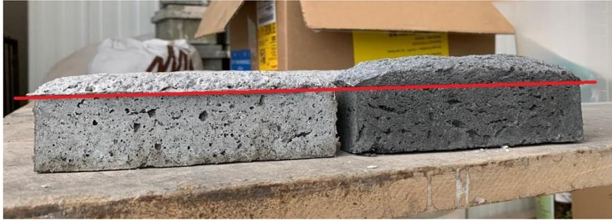
*Fig. 4.12 – Confronto tra i provini ottenuti con la miscela schiuma più carbonio e quella con il trattenuto al setaccio 0,5 mm. La linea rossa indica il limite superiore del provino e quindi il rigonfiamento dei provini.*
