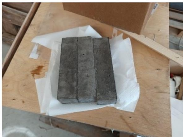
*Fig. 4.6 – Provini ottenuti dopo il disarmo.*
