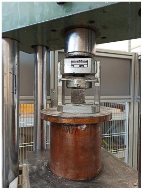
*Fig. 4.10 – Setup di prova a compressione dei provini*
