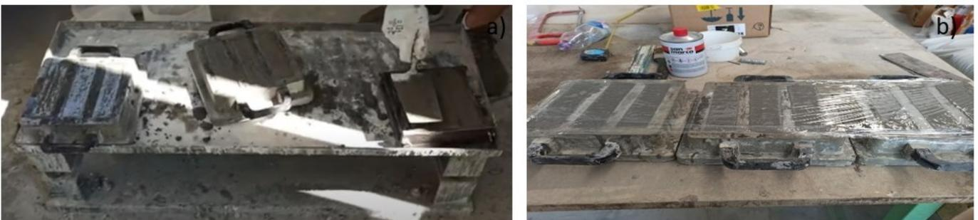
Fig. 4.5 – Fase di vibratura (a) e di copertura, con uno strato di pellicola, della miscela negli appositi casseri (b).
