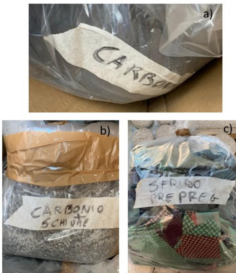
Fig. 2.5 – Materiale inviato dall'azienda HP Composites: polvere di carbonio (a), miscela di carbonio e di schiuma (b) e scarti di tessuti polimero-impregnati di scarto (prepeg) (c).
