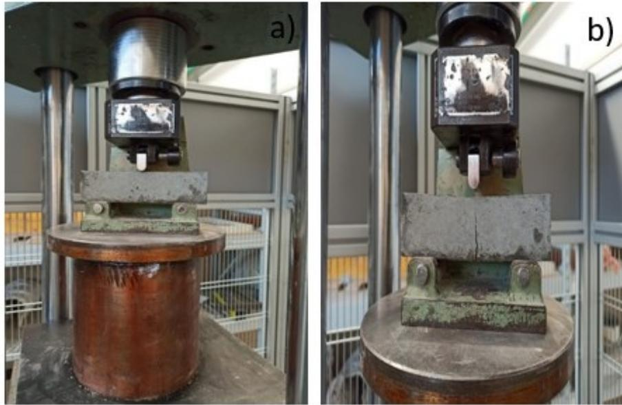
*Fig. 4.9 - Setup di prova a flessione dei provini. Inizio della prova (a) e fine della prova (b)*
