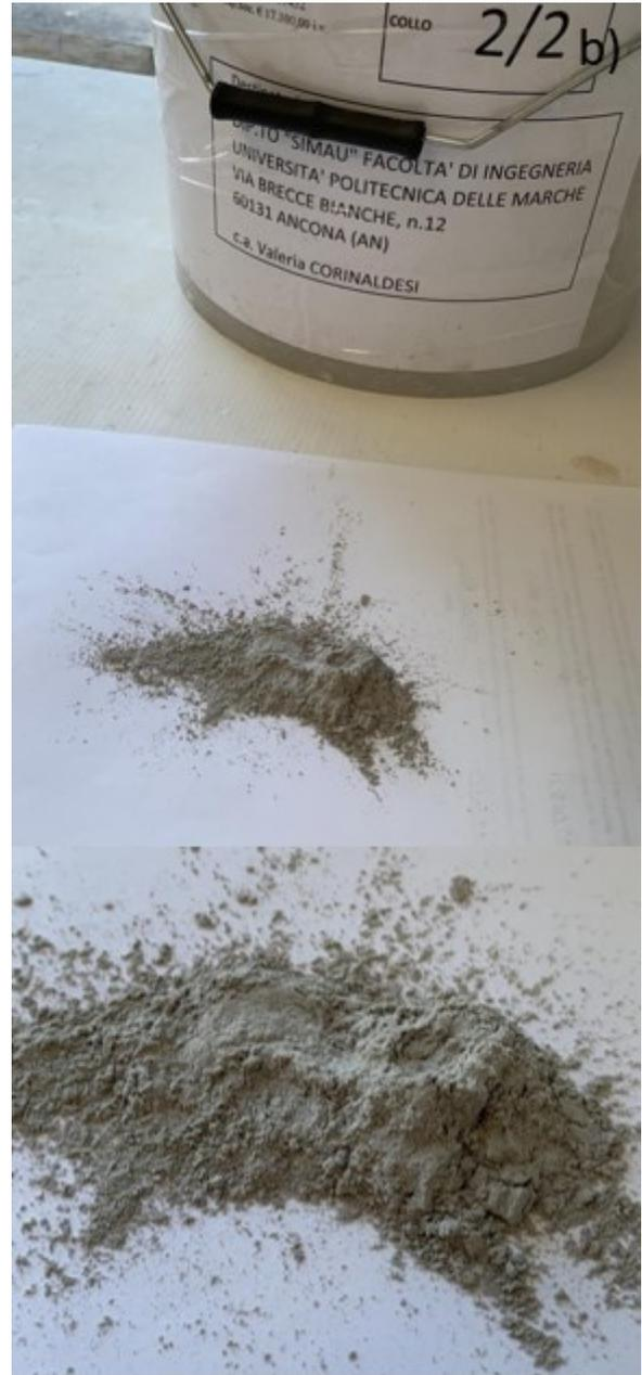
*Fig. 2.1– Scarti di produzione di lavelli: frazione grossolana (a) e frazione fine (b).*
