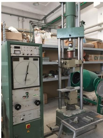
*Fig. 4.8 – Pressa idraulica.*
