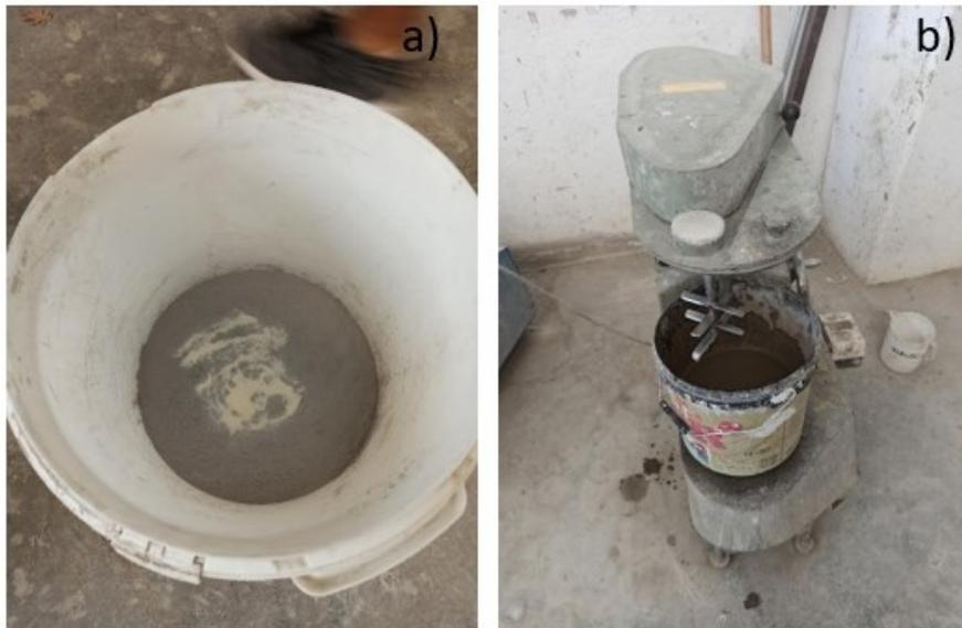
Fig. 4,4 – Preparazione (a) e miscelazione dell'impasto del getto (b).
