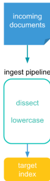
Figura 5.1: Struttura generale di una Ingest Pipeline
