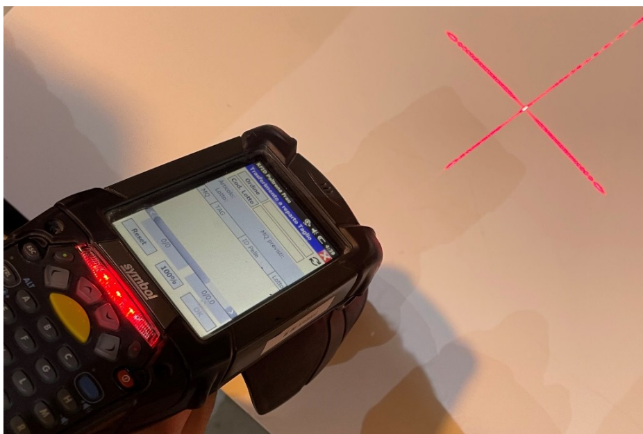
Figura 5.1 - Funzionamento del dispositivo di lettura laser del palmare
