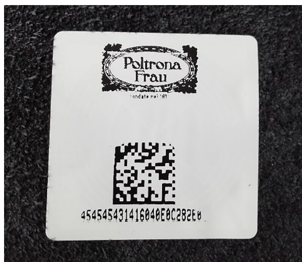
Figura 2.5 - Tag RFID presente sulla superficie inferiore della pelle
