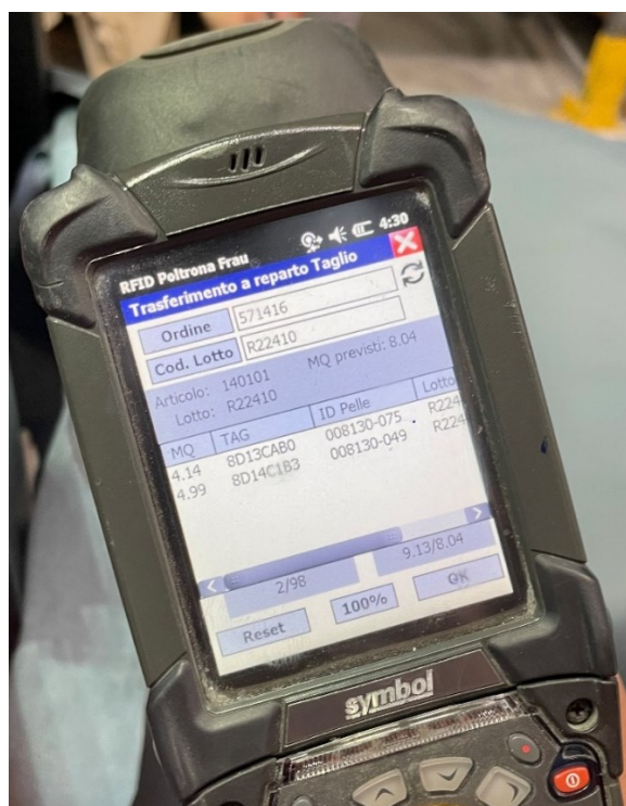
Figura 5.2 - Schermata di trasferimento a reparto di taglio del palmare
