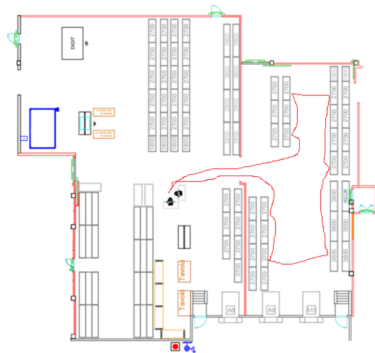
Figura 7.2 - Spaghetti chart to-be del magazzino pelle nel caso del prelievo di una famiglia di pelli
