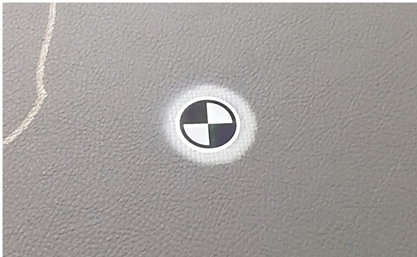
Figura 2.18 - Tag di riferimento per la centratura del concio preliminare alla fase di taglio
