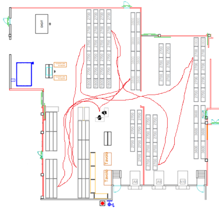
Figura 7.1 - Spaghetti chart as-is del magazzino pelle nel caso del prelievo di una famiglia di pelli
