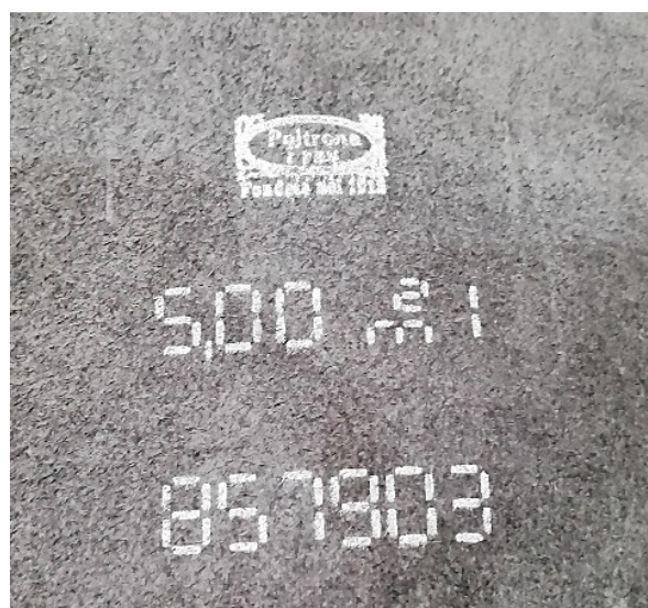
Figura 2.6 - Metratura e codice pelle presente sulla superficie inferiore della pelle
