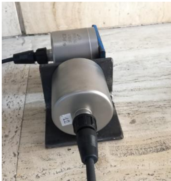
Figura 37 Coppia di accelerometri piezoelettrici situati sul punto C (in direzione X e Y).
