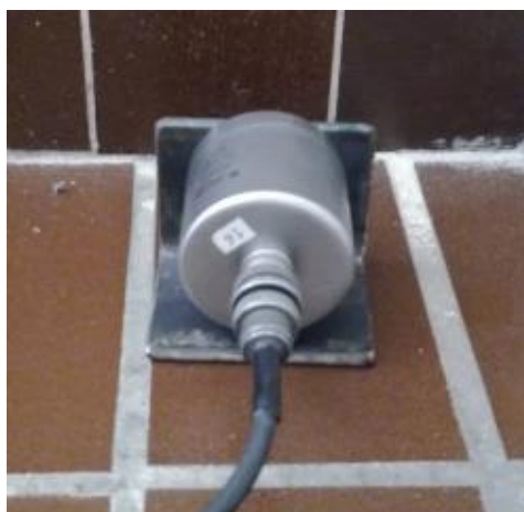
Figura 35 Accelerometro piezoelettrico situato sul punto B (in direzione X).
