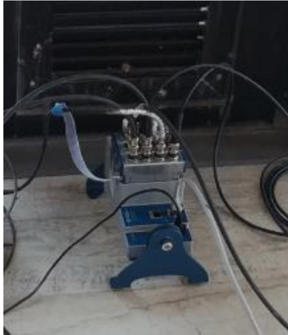
Figura 38 Accelerometro piezoelettrico situato sul punto D (in direzione Y).
