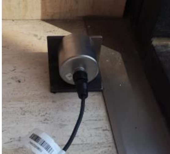
Figura 38 Accelerometro piezoelettrico situato sul punto D (in direzione Y).
