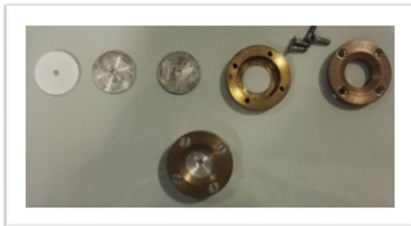
Fig. 2.4: Composizione della slot: singole componenti (sopra) ed assemblata (sotto).
