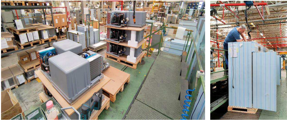
Fig. 3.15 – Da sinistra: gruppi motore su soppalco, operatore durante il montaggio in testa al frigo
