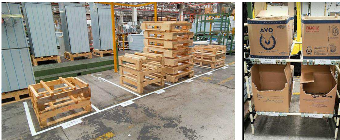
Fig. 4.18 – Marcatura a terra delle basi imballo e mobiletto piedi e ruote con etichette
