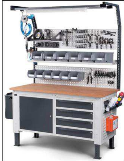
Fig. 4.21 – Esempio di futuro banco con pannello attrezzato
