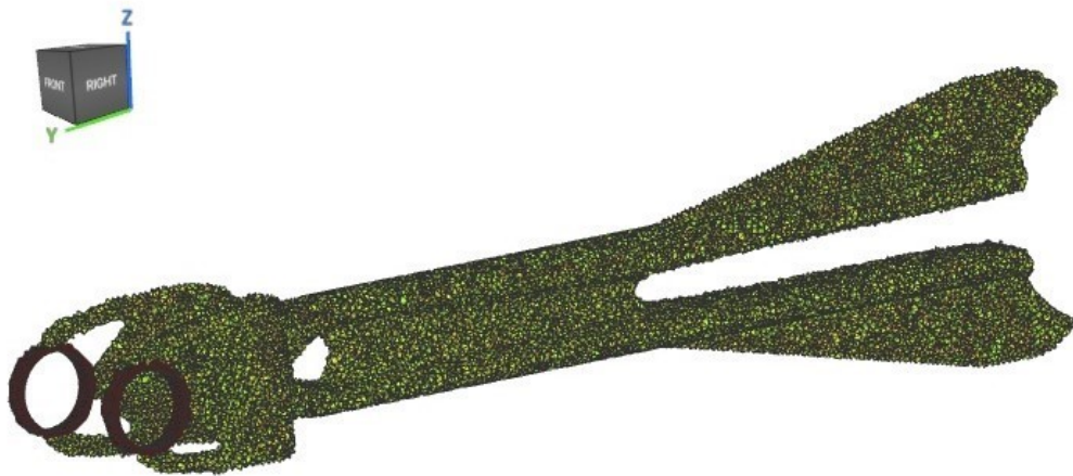
Figura 6.5: visione Thresholded-elements del componente ottimizzato
