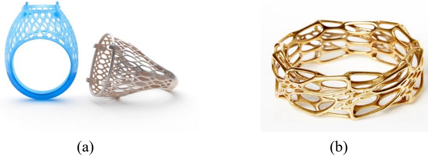
Figura 1.5: (a) (b) esempi di anelli realizzati attraverso la stampa 3D
