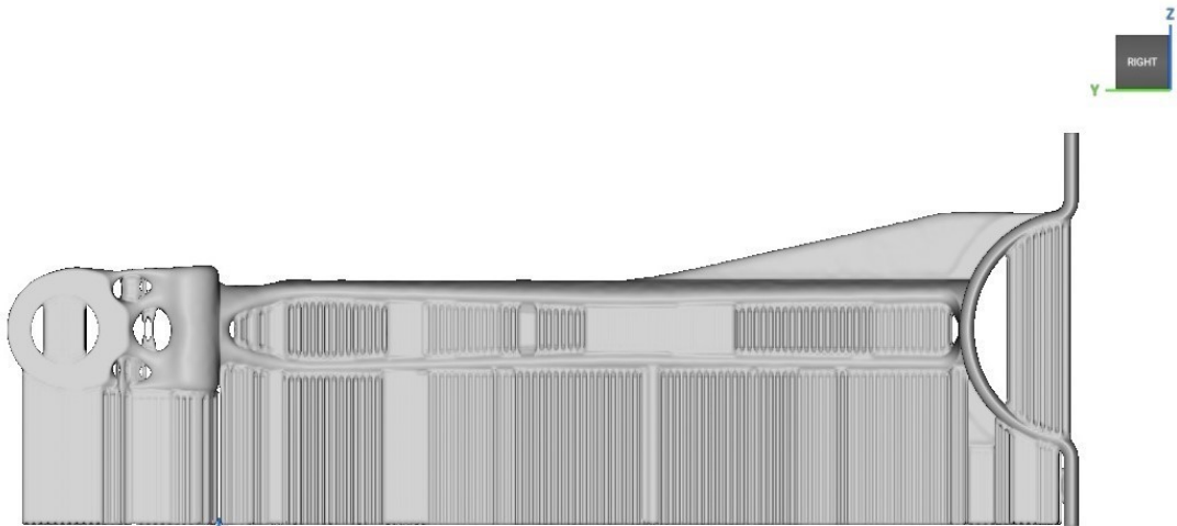
Figura 6.19: struttura di supporto Square honeycomb
