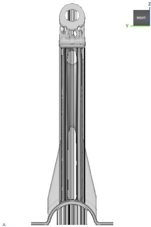
Figura 6.11: struttura di supporto Columns
