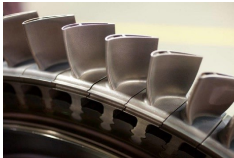
Figura 1.2: palette di una turbina a gas
