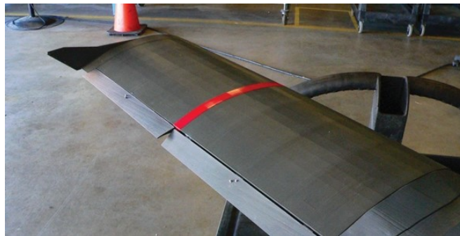
Figura 1.3: ala di un aeromobile stampata in 3D con tecnologia FDM
