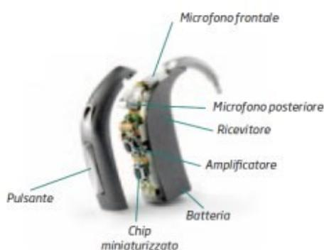
*Fig 2.2.1: Componenti fondamentali di un apparecchio acustico<sup>8</sup>*
