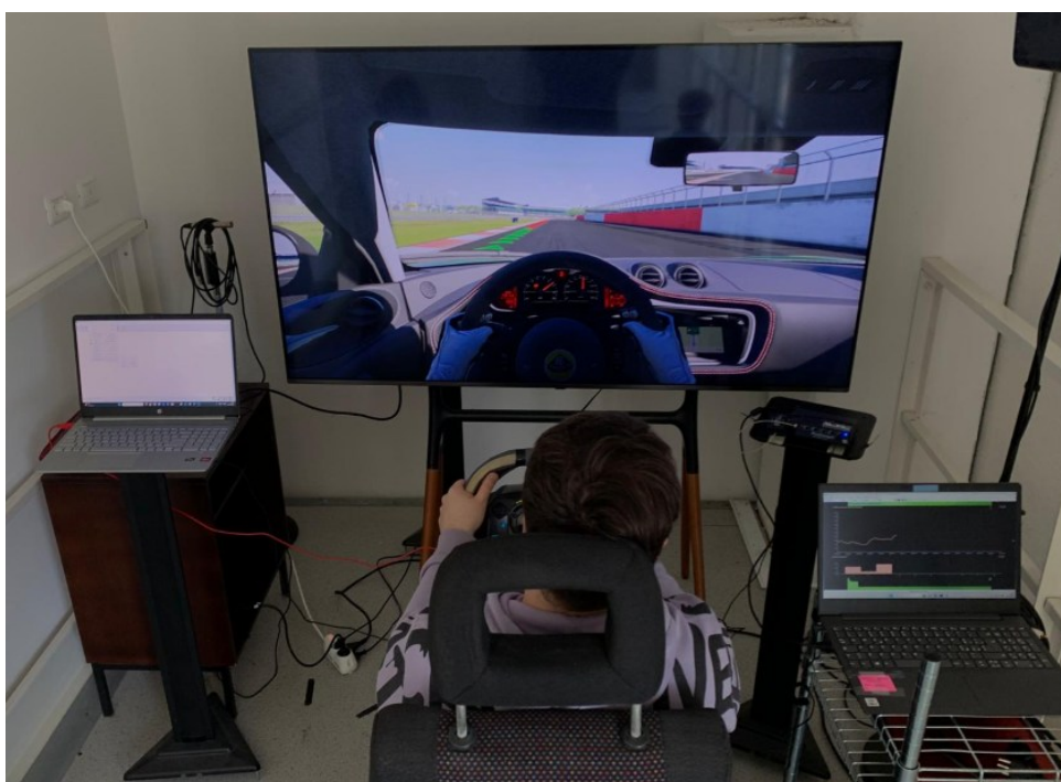
Figura 23: Acquisizione del segnale elettrodermico durante la prova di guida simulata mediante sensore con piastre in rame e sistema ProComp5 Infiniti.
