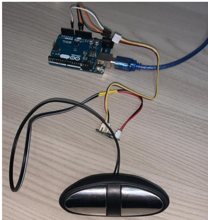
Figura 21: Collegamento tra il sensore cardiaco a contatto e la scheda Arduino Uno Rev3 SMD usato nella seconda prova sperimentale.
