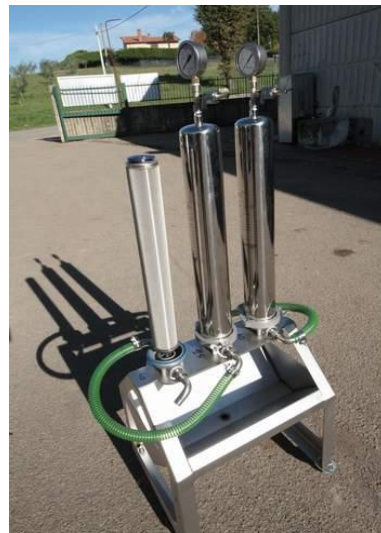
Figura 4.5 Impianto di filtrazione
