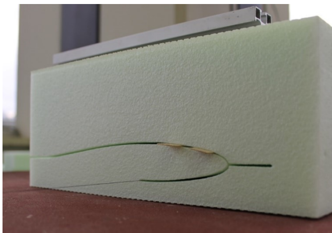
Figura 1.17: Particolare del taglio del polistirene estruso. Sono stati inseriti degli spessori durante il taglio per compensare la deformazione del materiale durante il taglio stesso.
