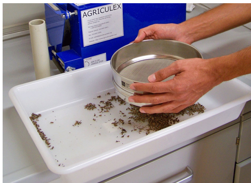
Figura 7.4.1 – L'immagine rappresenta un setaccio con il quale vengono eliminate le impurità dai semi
