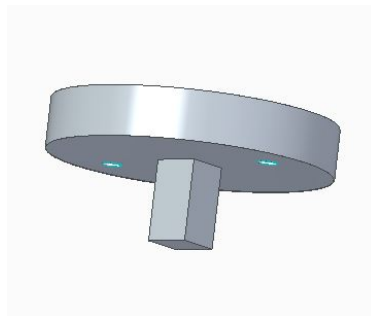
Figura 3.7.: Piastra adibita alla trasmissione della torsione
