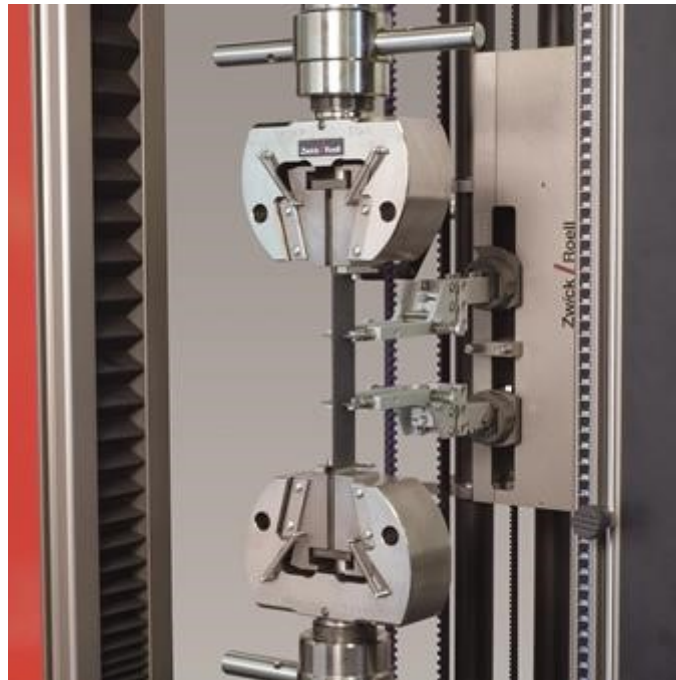
Figura 3.5 – Macchinario per l'esecuzione della prova di trazione su provini compositi
