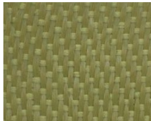
Figura 2.20 – Schematizzazione ed esempio di raso in fibre di aramide
