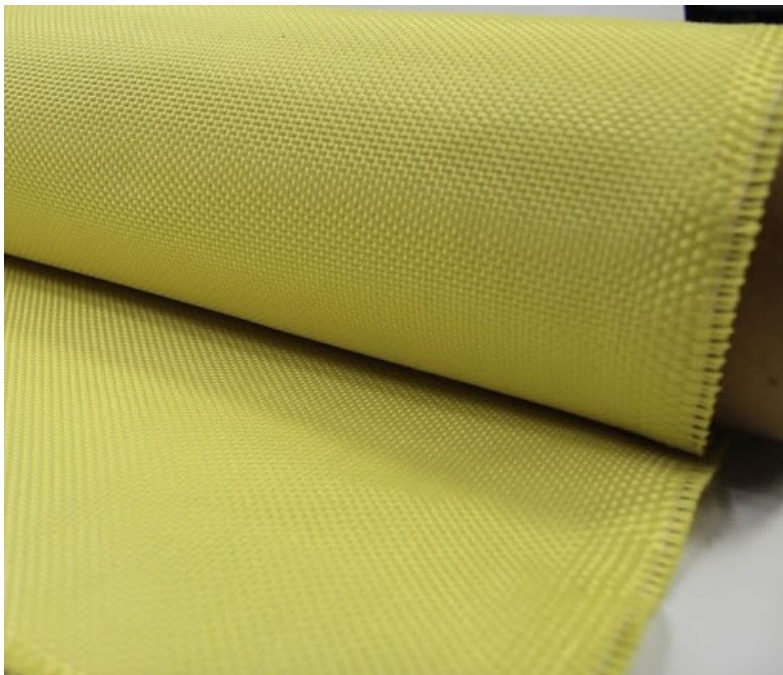
Figura 2.9 – Rotolo di tessuto in fibra di aramide
