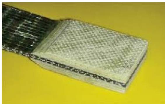
Figura 3.1 – Tallone in composito rinforzato in fibra di vetro
