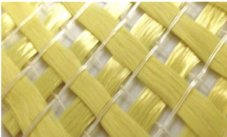
Figura 2.10 – Rete di rinforzo in fibra di aramide
