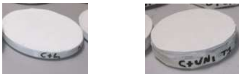
Figura 24- Provini cilindrici diametro 8 cm C-L, C-UNI-T1
