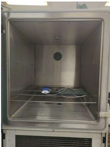
Figura 31 - Allestimento camera climatica
