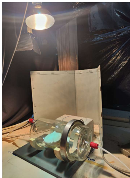
Figura 41- Allestimento per la misurazione dell'effetto fotocatalitico
