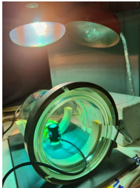
Figura 38 - Allestimento per la misurazione dell'irradianza
