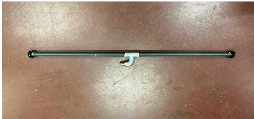
Fig.6.1 Immagine del condotto in PVC sezionato e con l'aggiunta della valvola centrale
