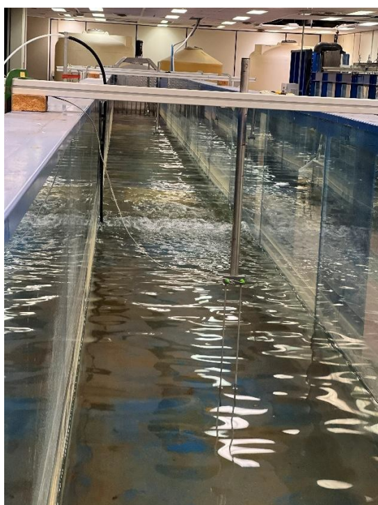
Fig.7.2 Dettagli della cortina di bolle vista dall'alto (a sinistra), elettrodi della sonda (a destra)
