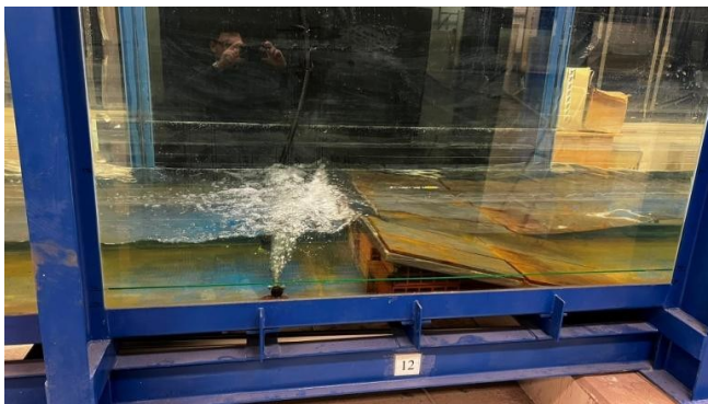
Fig.10.3 Onde frangenti a ridosso della cortina di bolle in funzione
