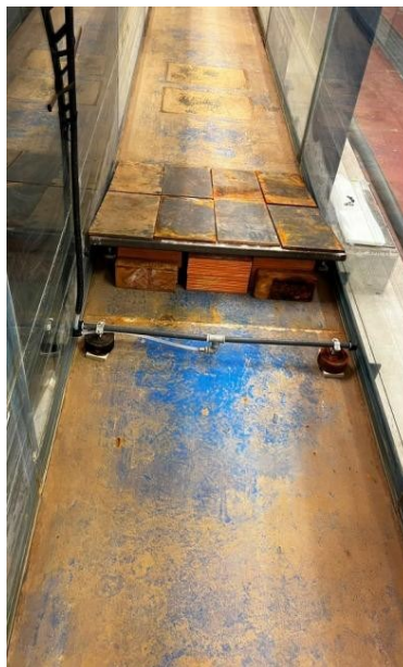
Fig. 10.1 Dettaglio della rampa utilizzata per far frangere l'onda riducendo il tirante idraulico
