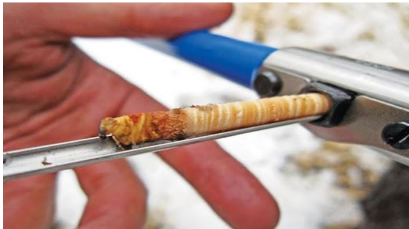
Figura 3.11 Trivella di Pressler per l'estrazione delle carote incrementali
