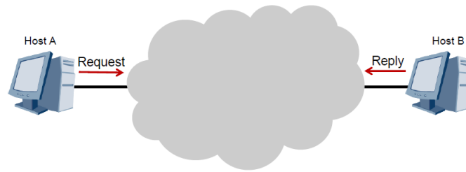
Figura 2.8: UDP usato per singole interazioni request-reply
