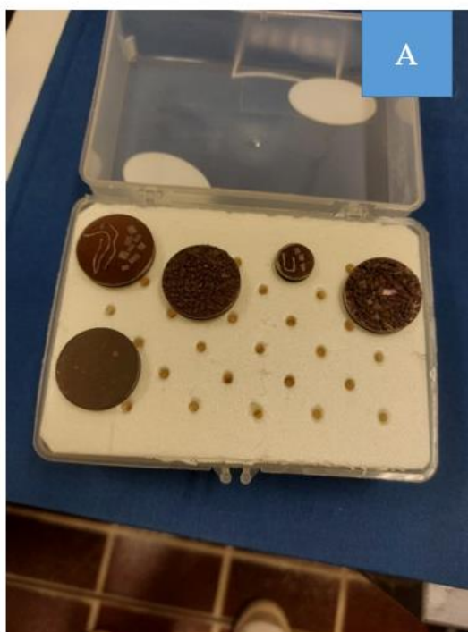
Figura 9. Campioni sui dischetti di carbonio (A), apposto sistema per l'inserimento dei campioni nel microscopio (B).
