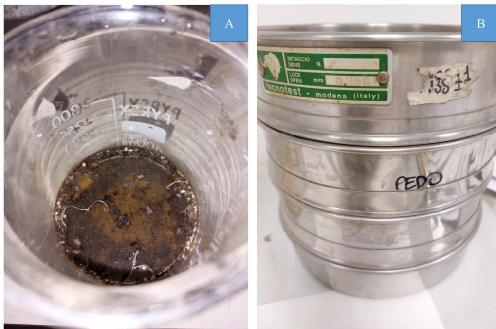
Figura 6. Becher con campione di suolo e acqua distillata (A), vagli per la separazione delle varie frazioni di terra fine (B).
