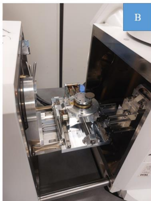
Figura 9. Campioni sui dischetti di carbonio (A), apposto sistema per l'inserimento dei campioni nel microscopio (B).
