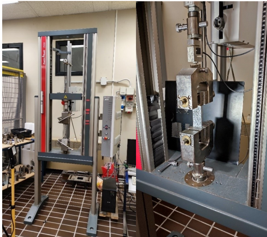
Fig. 48 – Setup di prova a trazione eseguito con la macchina Zwick/Roell Z050.
