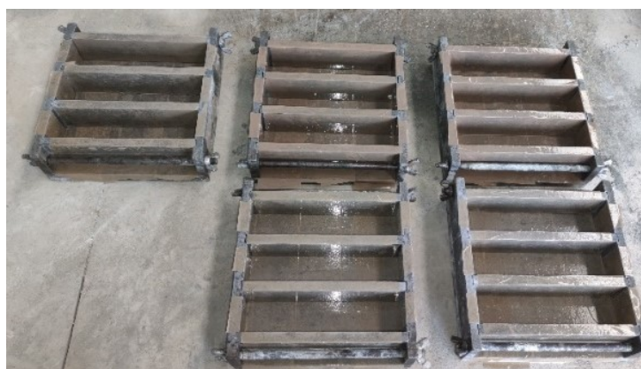
Fig. 18 – Casseri in metallo 16 x 4 x 4 cm 3 con scotch per provini di malta geopolimerica.
