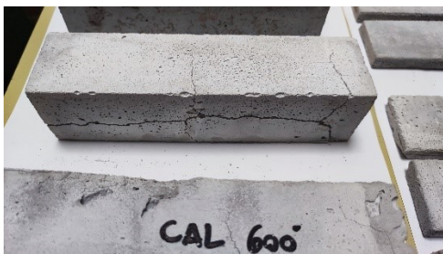
Fig. 41- Ispezione visiva dei campioni dopo il trattamento termico, Formazione di fessure in un provino CAL 600°C a sinistra, Imbarcamento dei provini MKK 600°C a destra.
