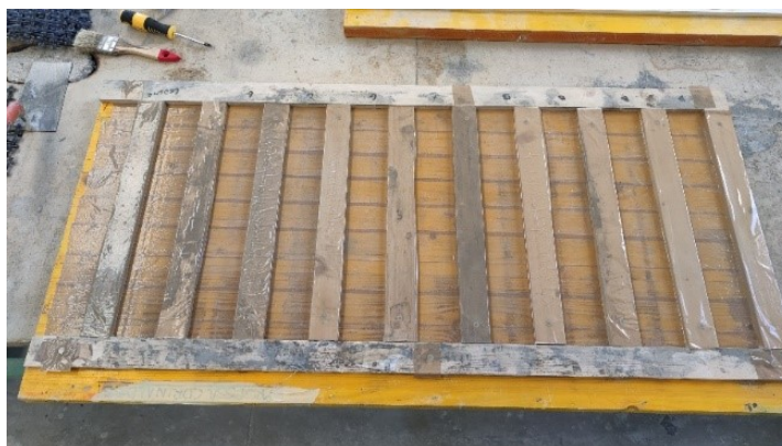
Fig. 20 – Casseri in legno 38 x 6 x 1 cm 3 con scotch per provini in composito con malta geopolimerica
