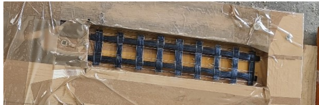
Fig. 23 - Rete in basalto per provini 19 \times 4 \times 1 \text{ cm}^3 con termocoppia (2 yarn).
