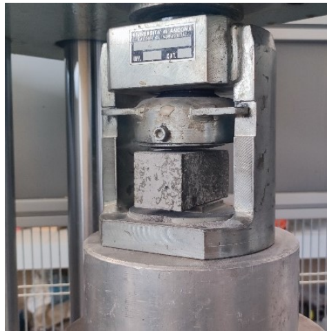
Fig. 45 – Setup di prova a compressione.
