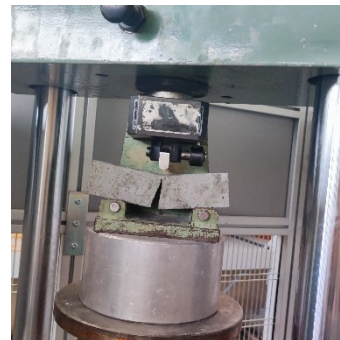
Fig. 44 – Macchina di compressione Galbadini usata nella sperimentazione a sinistra; Setup di prova a flessione a destra prima e dopo la rottura.
