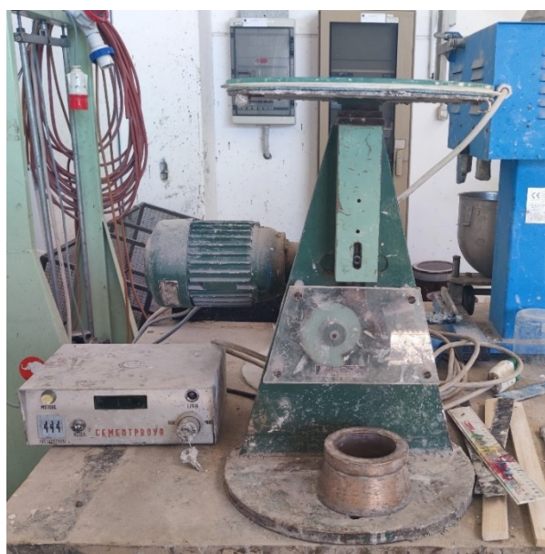
Fig. 37 – Tavola a scosse e stampo troncoconico come da normativa UNI.
