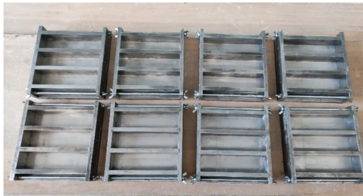
Fig. 17 – Casseri in metallo 16 x 4 x 4 cm 3 con disarmante per provini di malta commerciale.
