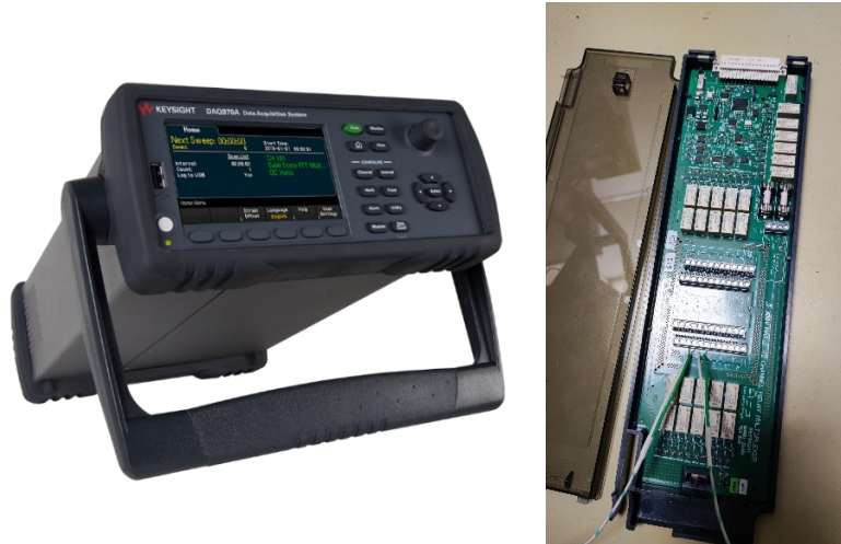
Fig. 39 – Registratore di dati a sinistra; Esempio di collegamento di due termocoppie a destra.
