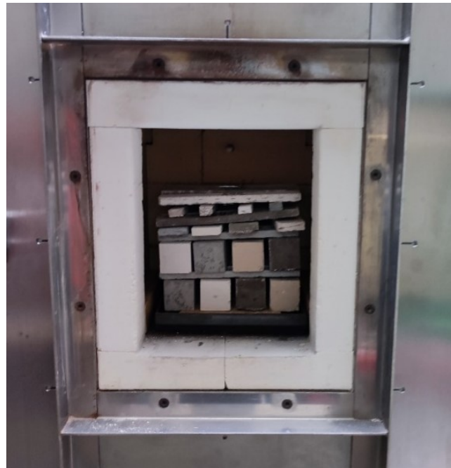
Fig. 38 – Disposizione dei provini in forno per la cottura a 200°C (medesima disposizione per le cotture a 400°C e 600°C).
