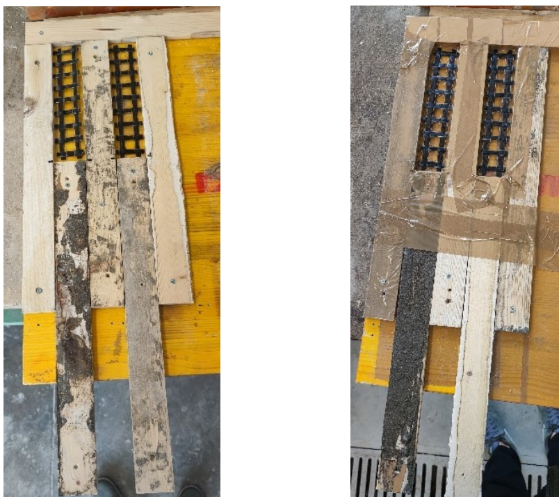
Fig. 21 – Casseri in legno 19 x 4 x 1 cm 3 per malta commerciale a sinistra, per malta geopolimerica a destra.
