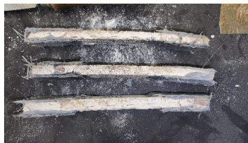
Fig. 41- Ispezione visiva dei campioni dopo il trattamento termico, Formazione di fessure in un provino CAL 600°C a sinistra, Imbarcamento dei provini MKK 600°C a destra.
