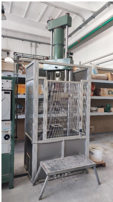
Fig. 44 – Macchina di compressione Galbadini usata nella sperimentazione a sinistra; Setup di prova a flessione a destra prima e dopo la rottura.
