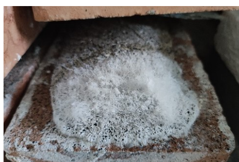
Fig. 33 – Efflorescenze causate dall'esposizione all'aria di una malta geopolimerica in sperimentazioni passate.
