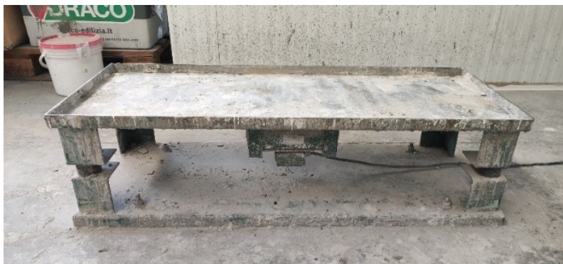
Fig. 32 – Tavola vibrante usata nella sperimentazione.
