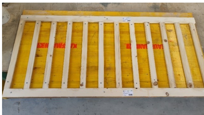
Fig. 19 – Casseri in legno 38 x 6 x 1 cm 3 con disarmante per provini in composito con malta commerciale.
