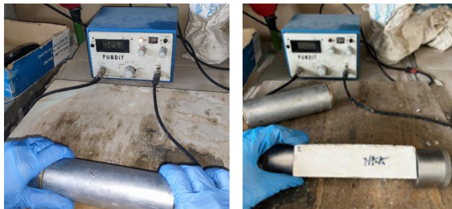
Fig. 42 – Calibrazione dello strumento e misura delle onde ultrasoniche su un provino 16 \times 4 \times 4 \text{ cm}^3 .
