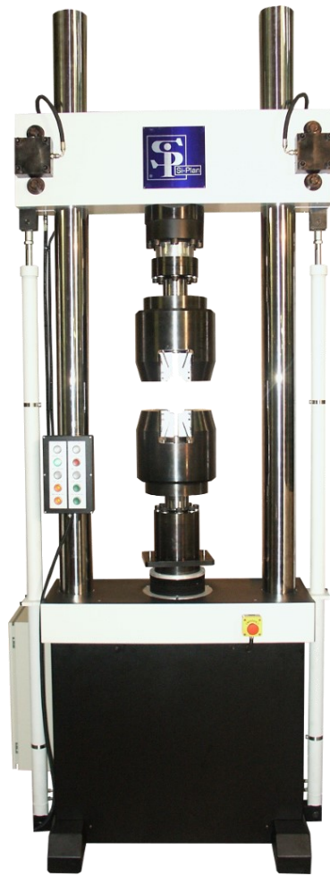
Figura 28. Macchinario test universale SiPlan.
