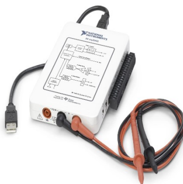
Figura 10. Scheda d'acquisizione MY-DAQ.
