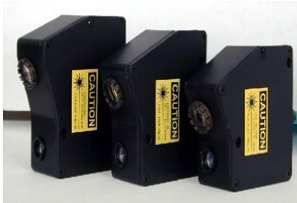
Figura 8. Sensori ottici a triangolazione MELsensor.
