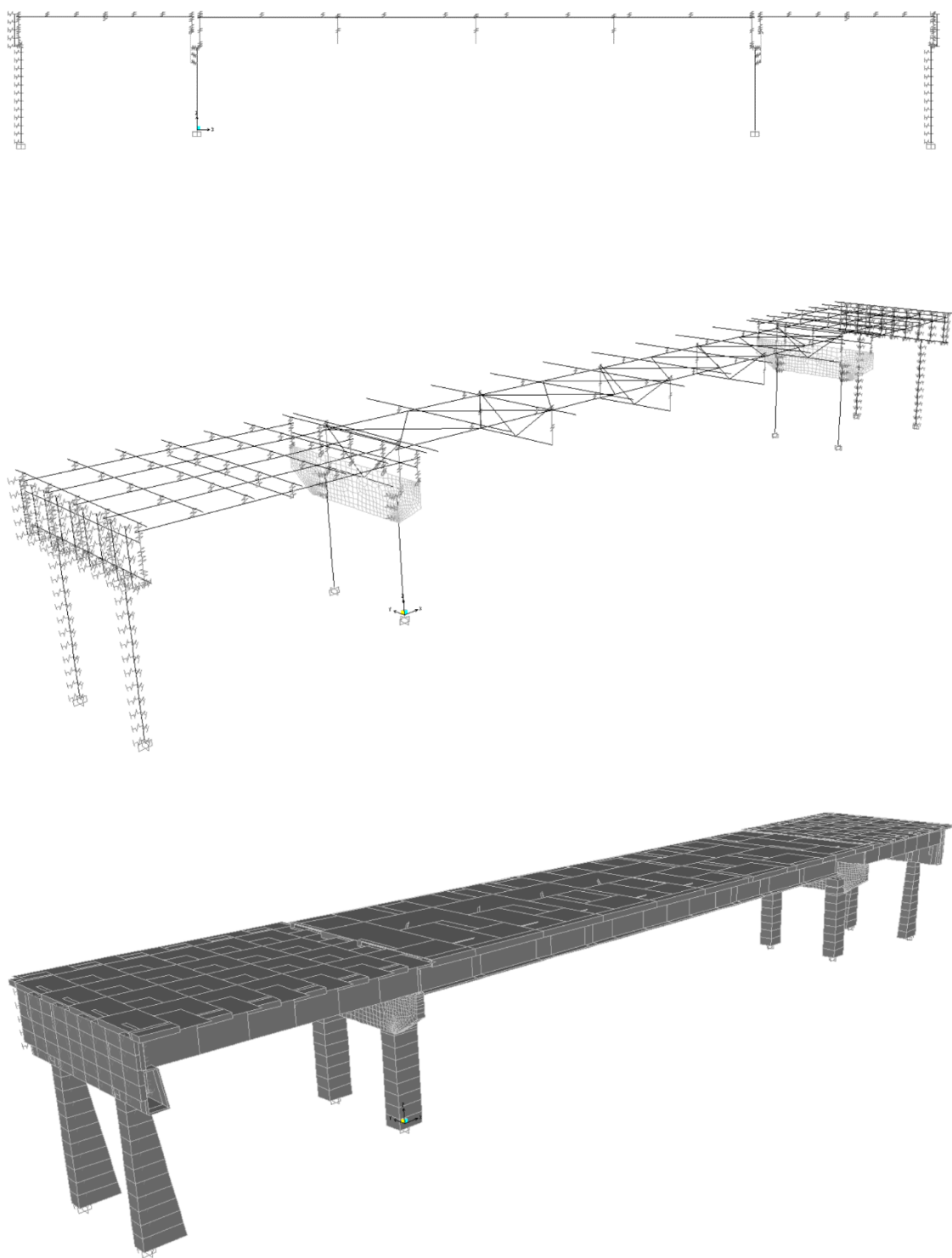
Figura 2.27 - Modello del cavalcavia 312 - Prospetto e viste tridimensionali
