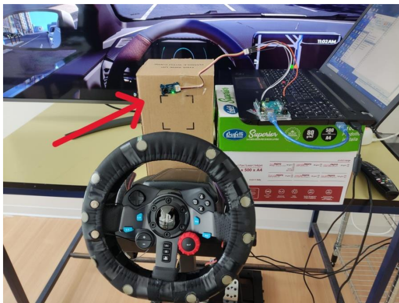
Figura 3.1 – Set-up di guida per il sensore “MLX90614”;
