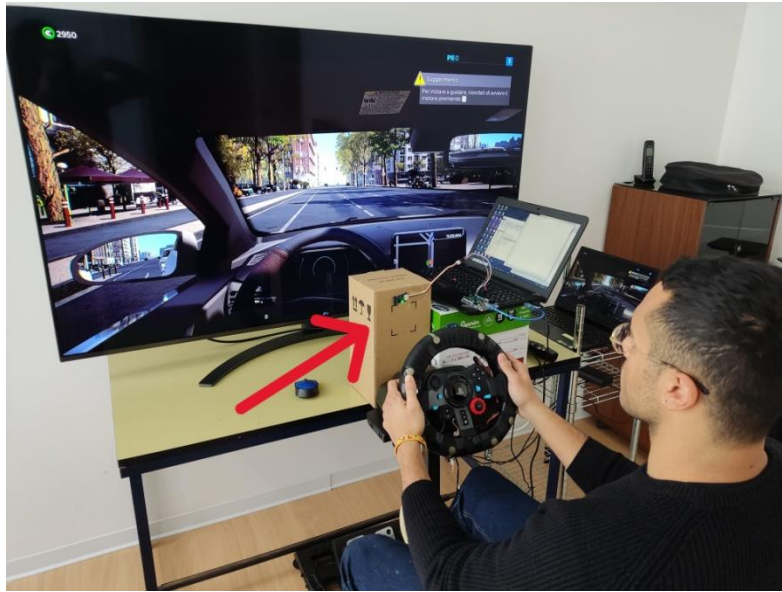
Figura 3.4 – Set-up di guida per il sensore “AMG8833”;
