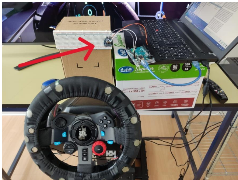
Figura 3.3 – Set-up di guida per il sensore “AMG8833”;
