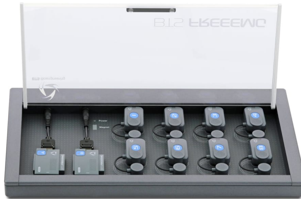
Figure 15: Elettromiografo wireless FREEEMG 1000
