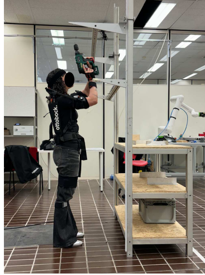
Figure 22: test statico con es-oscheletro
