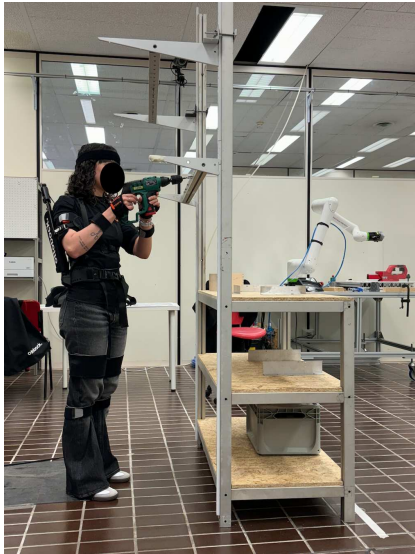
Figure 23: test dinamico con es-oscheletro con posizionamento frontale
