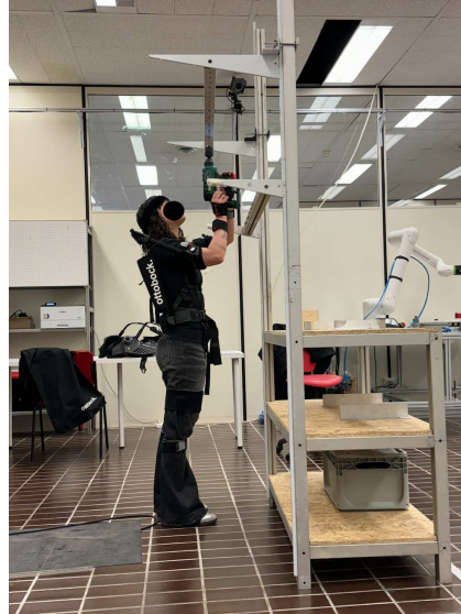
Figure 24: test dinamico con es-oscheletro con posizionamento over-head
