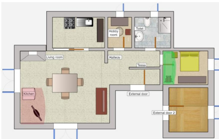
**Figura 32:** disposizione dei sensori, 2° caso; sono presenti solo il sensore frigo per la stanza 'Kitchen' e il sensore nella stanza 'Bedroom'. Le loro posizioni sono uguali a quelle che avevano nel 1° caso.
