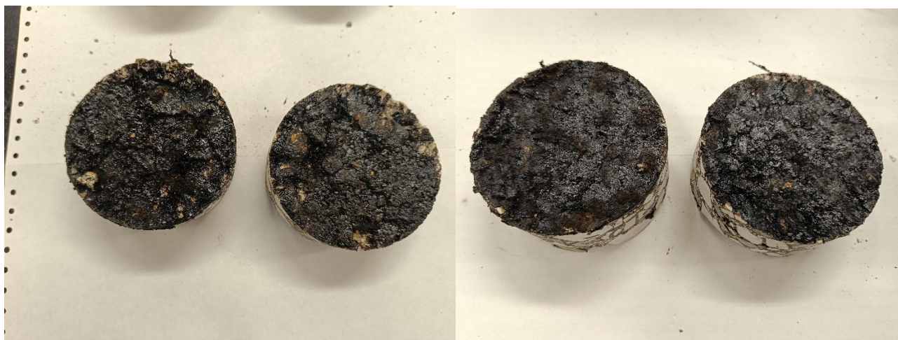
Figura 5.31 – Rottura provini geocomposito I2 a 120°C (sinistra), e a 160°C (destra)
