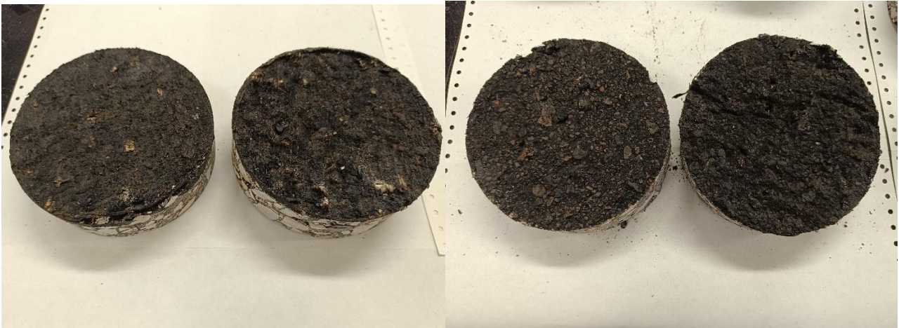
Figura 5.22 – Rottura provini geocomposito I1 a 120°C (sinistra), e a 160°C (destra)
