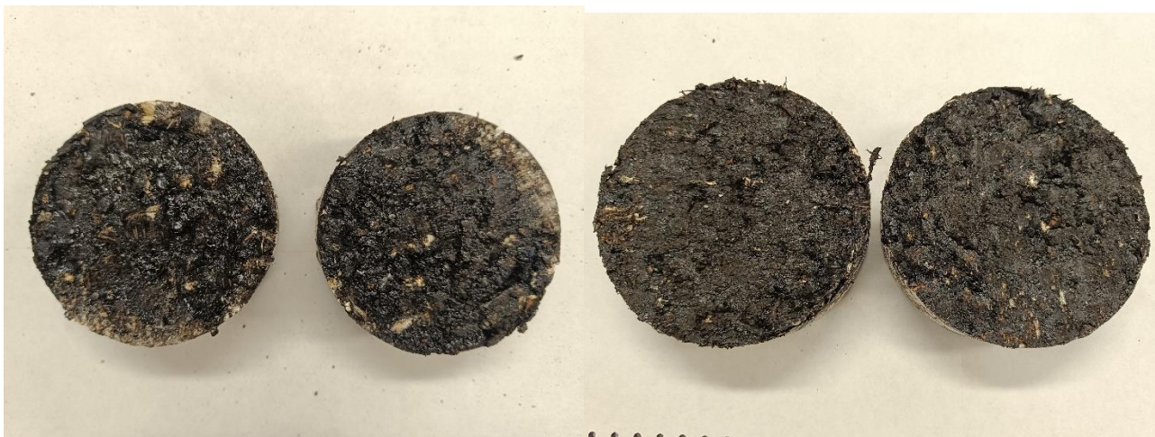
Figura 5.14 – Rottura provini geocomposito A2 a 120°C (sinistra), e a 160°C (destra)
