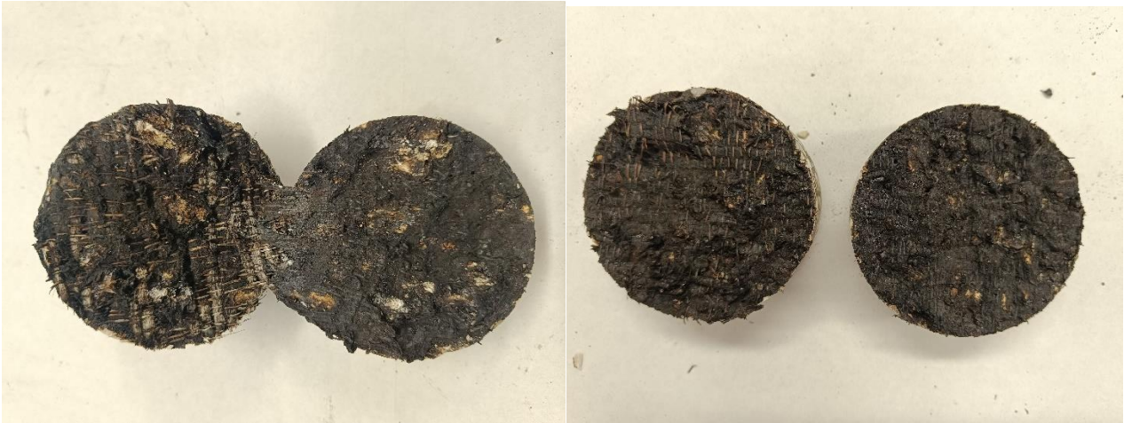
Figura 5.5 – Rottura provini geocomposito A1 a 120°C (sinistra), e a 160°C (destra)
