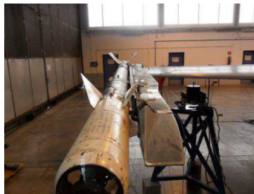
Figura 3.2: Carico fittizio montato sull'ala destra dell'F16
