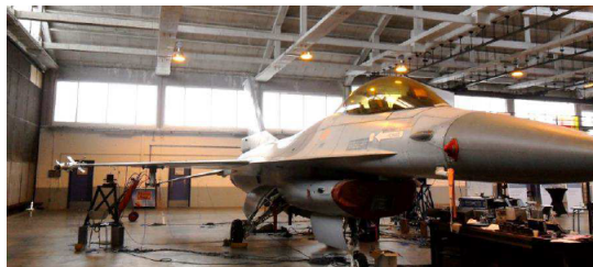
Figura 3.1: F-16; Test di vibrazione a terra presso base militare di Saffraanenberg.
