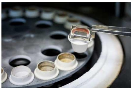
**Figura 0-7. Posizionamento dei crogioli nel carosello (Fonte: laboratorio biomasse).**
