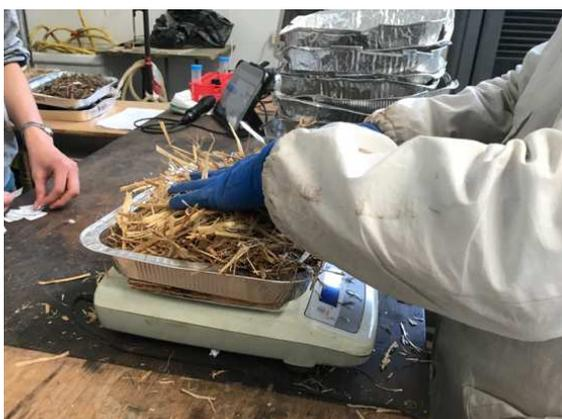
**Figura 0-5. Il campione pesato prima di essere messo in stufa.**
