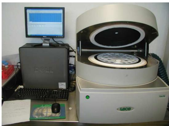
**Figura 0-11. Bilancia termogravimetrica per la determinazione del contenuto in ceneri.**
