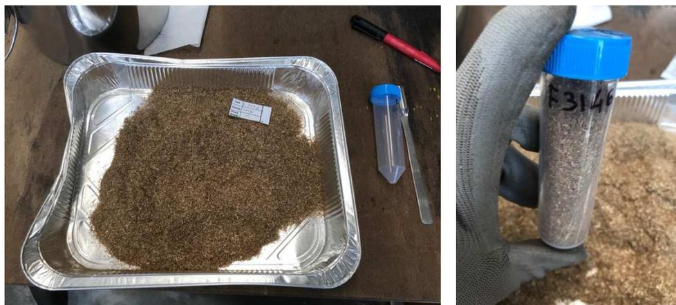
**Figura 0-6. Il campione una volta macinato a 1mm.**
