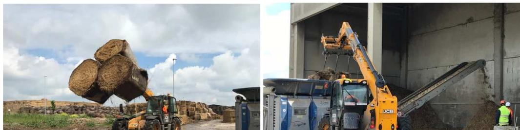
*Figura 0-1. A sinistra il trasporto delle balle verso la macchina trinciatrice, a destra la trinciatura.*
