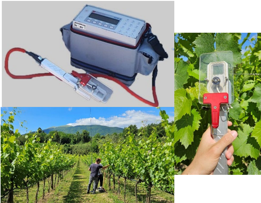
Figura 10. LCA-3 sistema portatile, analizzatore di gas ad infrarosso (ADC) e camera fogliare di tipo Parkinson.
