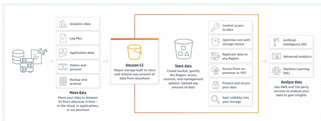
Figura 3.4: Diagramma che mostra come spostare, gestire i dati archiviati in S3 e come analizzarli utilizzando altri servizi
